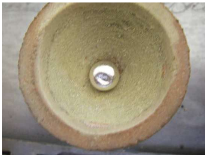
Figura 8.1. Perla de metal Doré obtenida mediante la técnica cuantitativa de ensayo a Fuego, en el paso No 9 de copelación.
