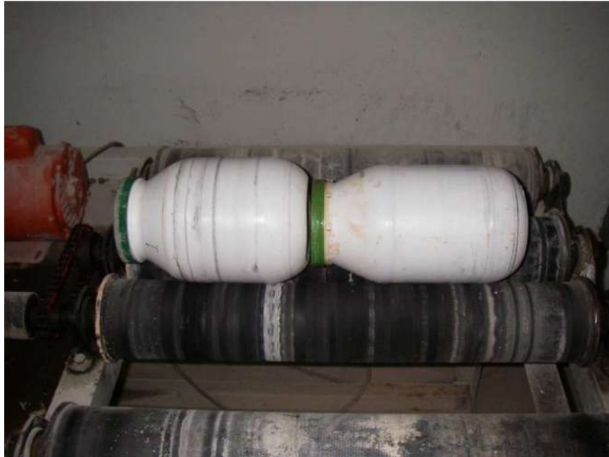
Figura 4.3. Prueba de botellas sobre el sistema de rodillos con los que se administra la agitación al sistema
