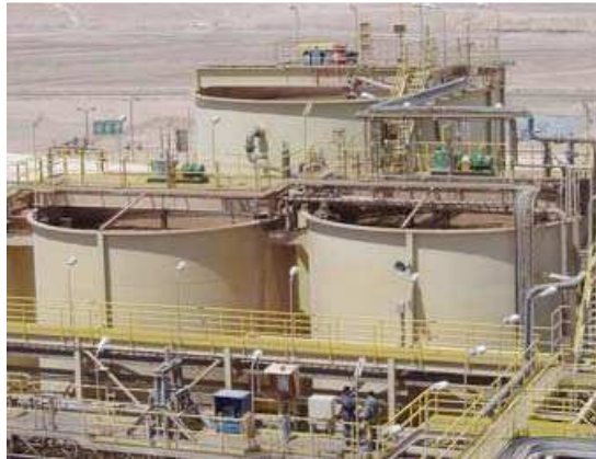
Figura 3.5 Lixiviación por agitación. Leyes mayores a 8 gr/TM [35]
