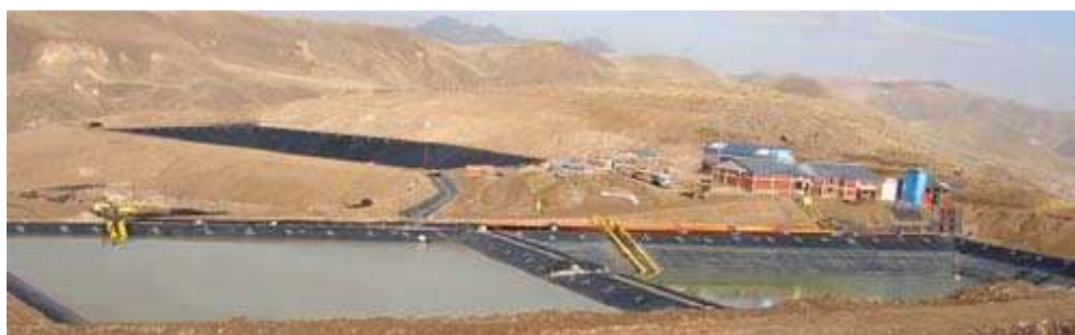
Figura 3.4 Lixiviación en batea “Vat leaching”. Leyes mayores a 6 gr/TM [35]
