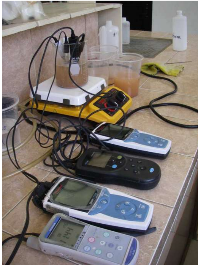
Figura 4.2. Muestra el proceso de lixiviación en el laboratorio con los sensores tomando lectura de ORP, Conductividad, pH y Oxígeno disuelto.
