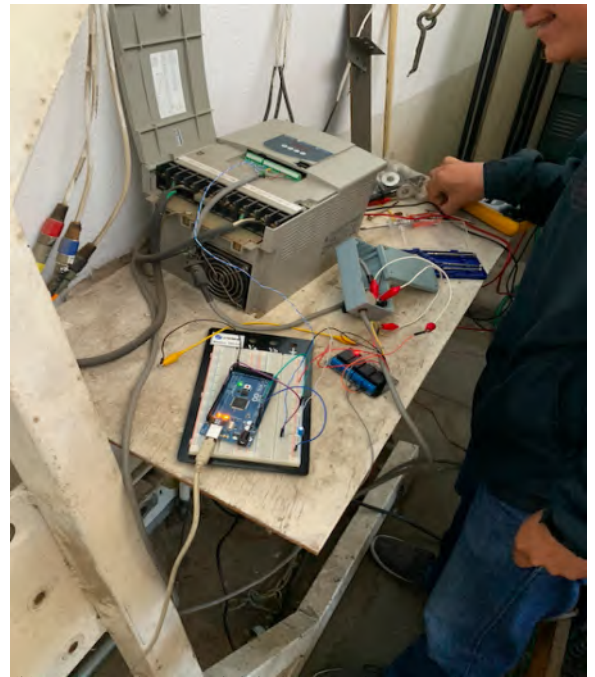
(b) Proceso de control del túnel de viento mediante la tarjeta de arduino.
