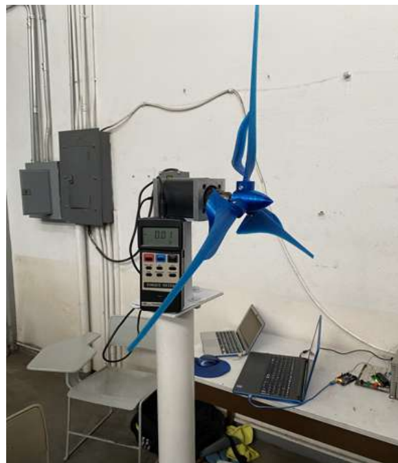
(b) Pruebas hechas al rotor de inducción midiendo el torque generado por medio de una sonda torquimetro.
