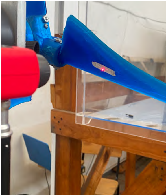
(c) Medición de respaldo mediante un tacómetro laser y una superficie reflectiva..
