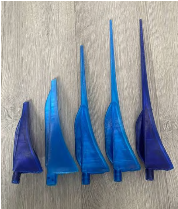
(a) Fabricación múltiple de álabes de inducción para encontrar las propiedades buscadas en el prototipo.
