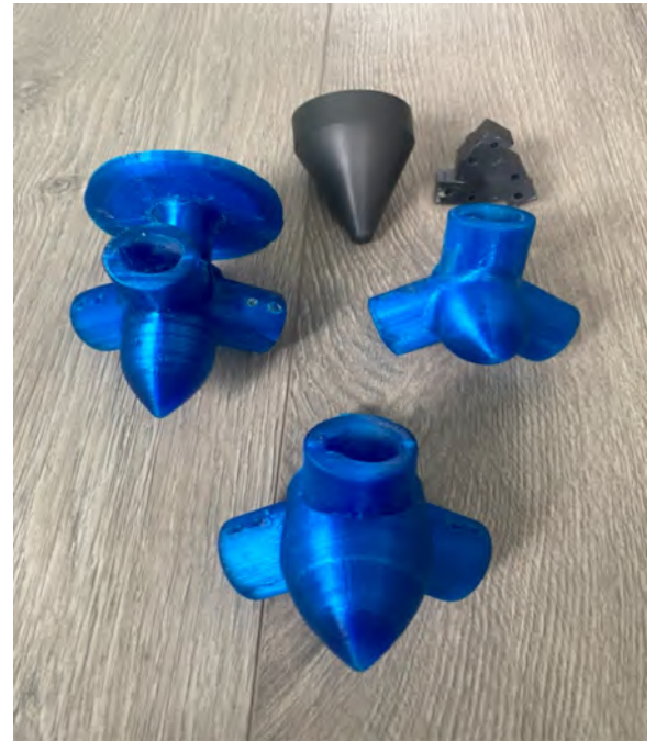
(b) Fabricación múltiple de hubs aerodinámicos para encontrar aquel con menor grado de desbalanceo en el proceso de fabricación.
