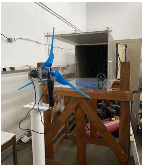
(c) Banco de prueba situado frente al túnel de viento tal que permita una incidencia de aire directa sobre el rotor.
