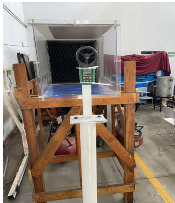
(d) Calibración del túnel de viento mediante una anemómetro de aspas.
