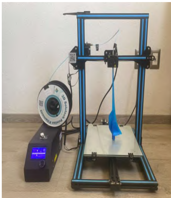
(a) Fabricación del álabes de inducción mediante tecnología 3D en material PETG.
