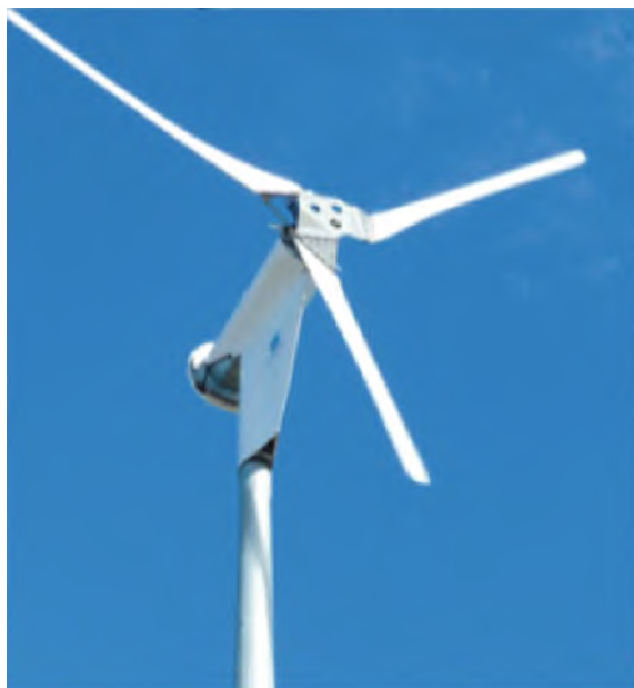
Figura 3.8: Turbina de eje horizontal de baja capacidad. [Vea Libro small wind turbines.]
