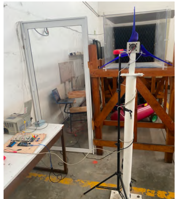
(d) Rotor de álabes de inducción con su instrumentación montada, su sistema de adquisición de datos y su guarda de protección para seguridad del operador.
