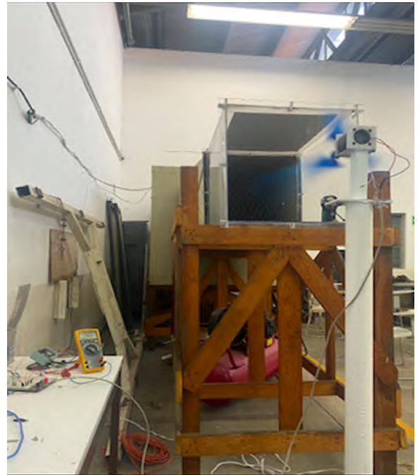
(d) Medición de variables en operación nominal para un rotor de álabes de inducción.
