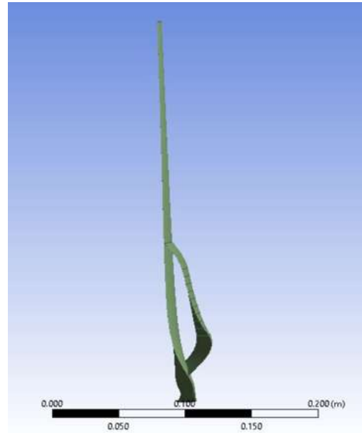
(b) Vista lateral del diseño de álabes de inducción 43 con ángulo de inducción \phi=7 .
