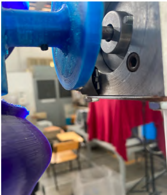
(c) Sensor efecto Hall montado sobre el generador y el imán sobre el cuerpo del rotor tal que permita sentir las revoluciones logradas por el rotor..
