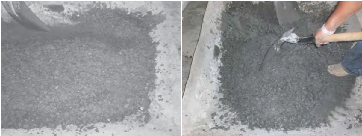
Figura 4.9. Material con buena trabajabilidad y muy homogénea
