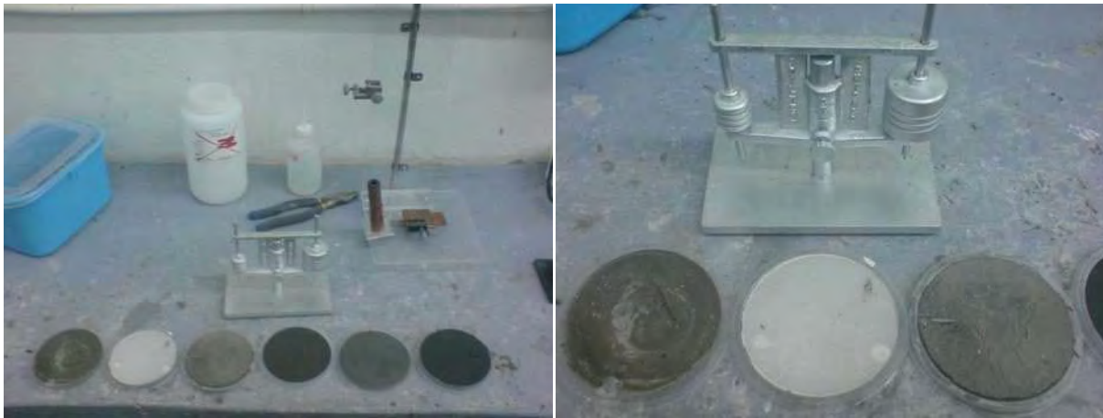
Figura 6.1. Equipo y muestras utilizadas para obtener tiempos de fraguado
