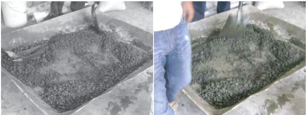
Figura 4.10. Material con mucha segregación
