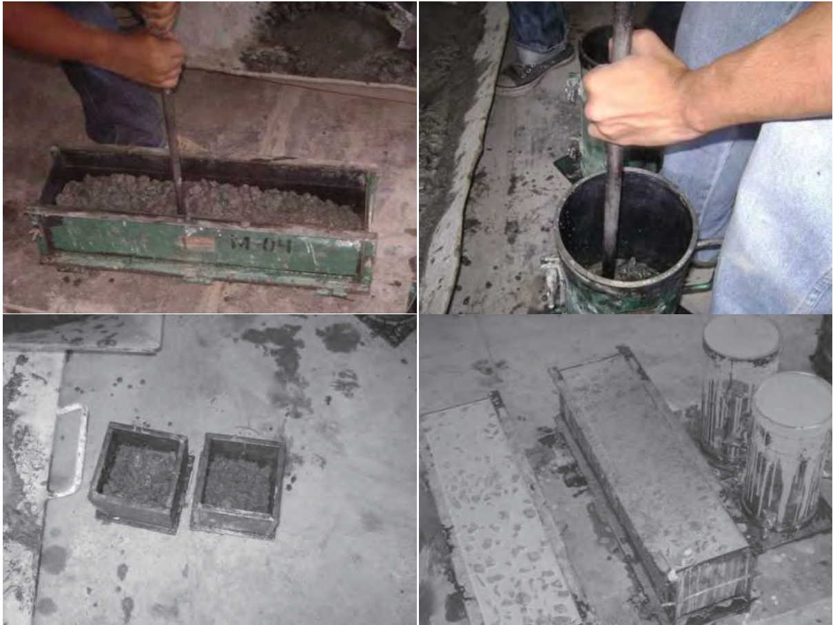
Figura 4.11. Llenado de los especímenes
