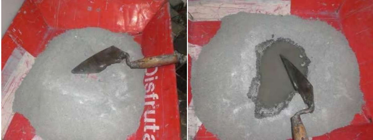
Figura 4.1. Mezclado del material en seco
