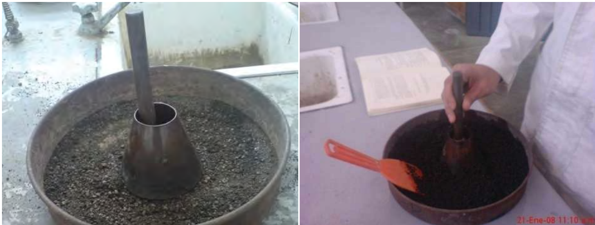
Figura 5.1. Humedad superficial y humedad de absorción en arenas
