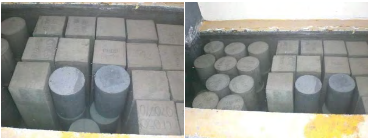
Figura 4.12. Curado de los especímenes
