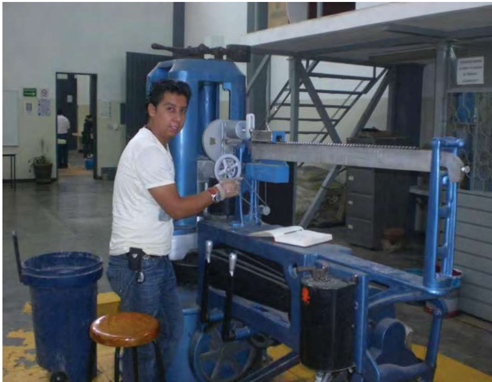
Figura 6.4. Prueba de especímenes a velocidad constante
