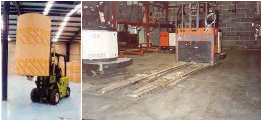
Figura 2.24. Diversos tipos de cargas vehiculares aplicadas sobre el piso
