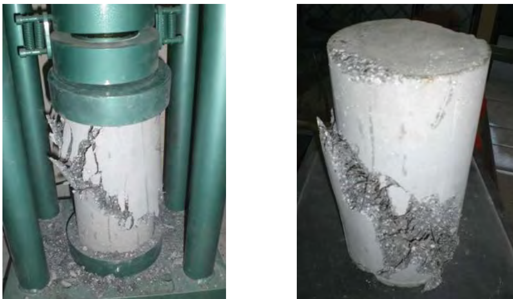
Figura 6.1. Prueba a compresión en cilindro, se observa su tipo de falla
