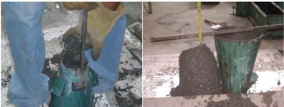
Figura 4.8. Prueba de revenimiento
