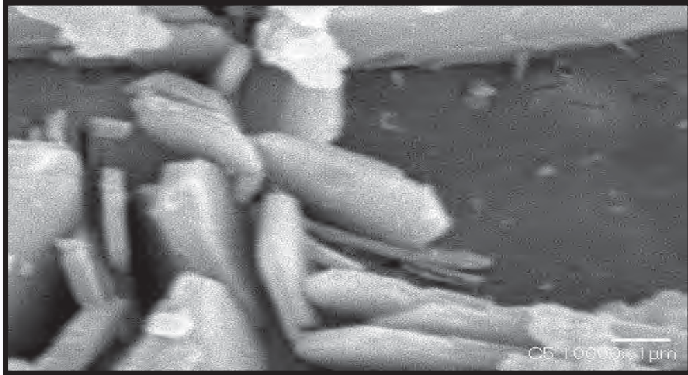
Figura 6.20. Acercamiento de la efluorescencia de los cristales de portlandita, observe su morfología hexagonal.
