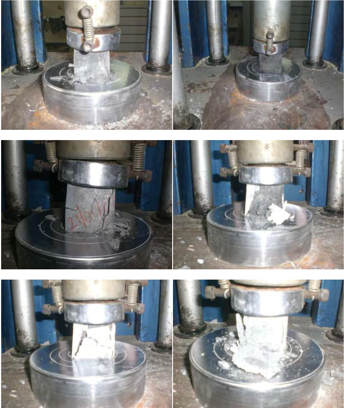
Figura 6.5. Imágenes de algunos especímenes llevados hasta la falla
