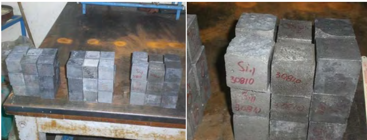
Figura 4.5. Desmolde de las muestras después de 24 horas
