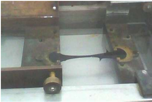
Fotografía No. 19: prueba de ductilidad; fuente propia
