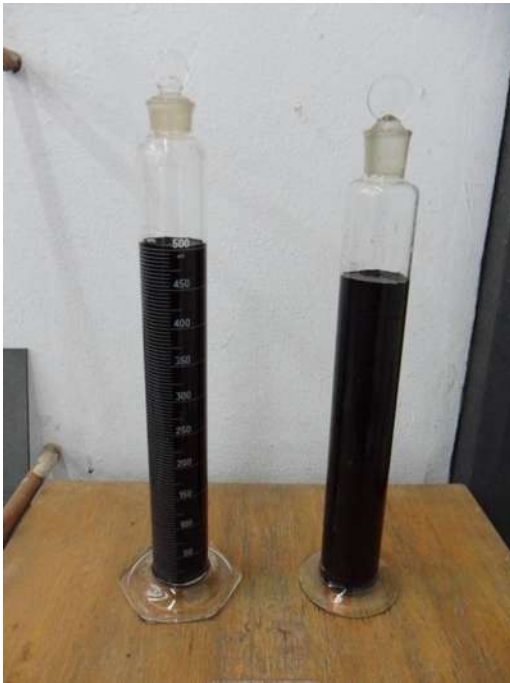
Fotografía No.23: probetas para la prueba de asentamiento a 5 días de; fuente propia
