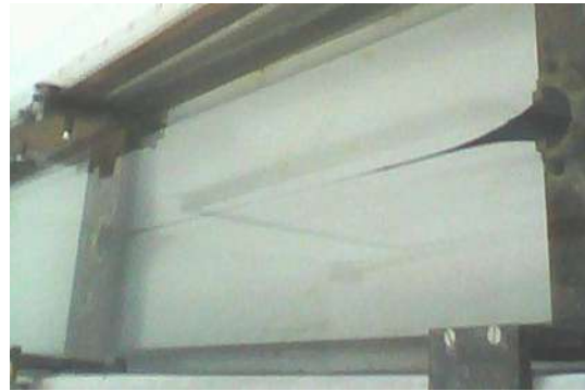
Fotografía No. 20: prueba de ductilidad; fuente propia
