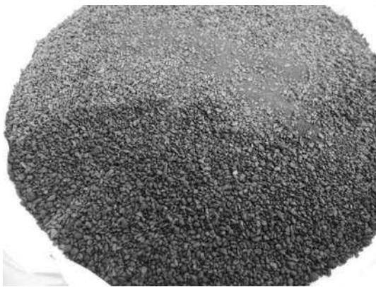
Fotografía No.43: muestra del agregado pétreo y emulsión estándar, para ser analizado por MEB ; fuente propia
