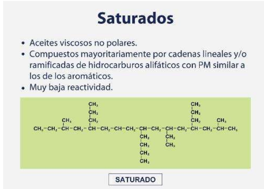
Figura No. 4: composición de los saturados; fuente Repsol®
