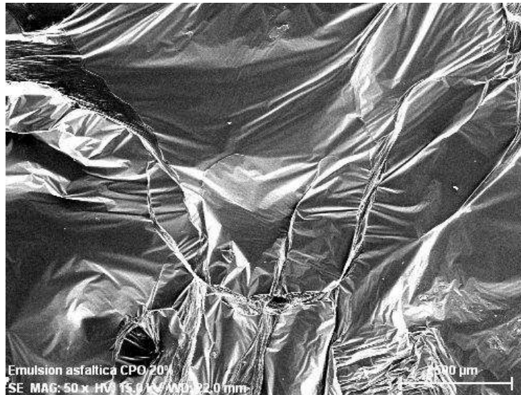
Microfotografía No.3: emulsión asfáltica modificada, analizada por MEB a 50x; fuente propia
