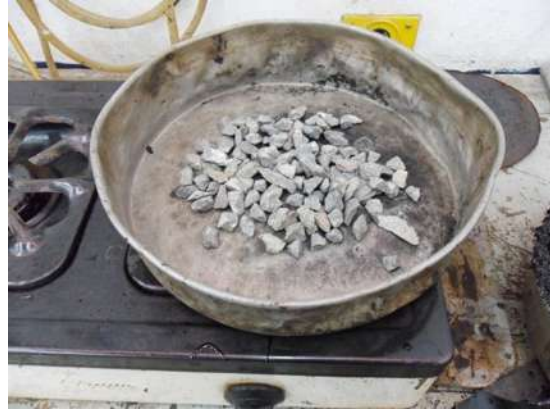
Fotografía No.30: secado del material en parrilla, prueba de densidad relativa; fuente propia
