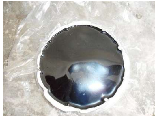
Fotografía No.48: emulsión asfáltica modificada para ser analizada por MEB; fuente propia
