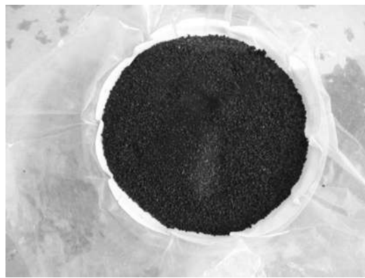
Fotografía No.44: muestra del agregado pétreo y emulsión modificada para ser analizado por MEB; fuente propia
