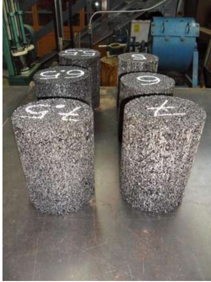
Fotografía No.40: elaboración de pastillas con mezcla modificada; fuente propia
