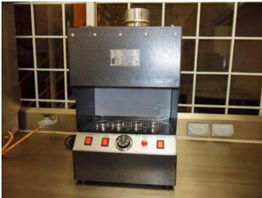
Fotografía No. 21: equipo para la prueba de viscosidad Saybolt Furol; fuente propia
