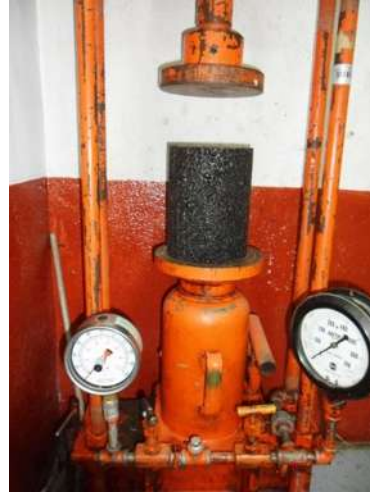
Fotografía No.39: prueba a la compresión simple sin confinamiento; fuente propia
