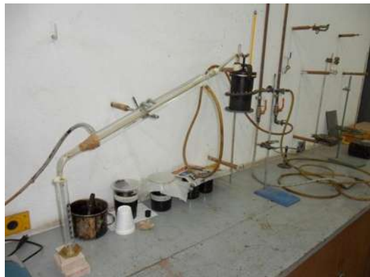
Fotografía No. 16: Prueba de destilación de emulsión asfáltica; fuente propia
