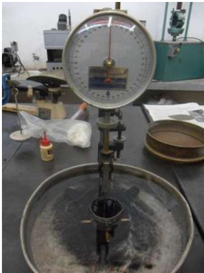
Fotografía No.17: prueba de penetración a residuo asfáltico; fuente propia
