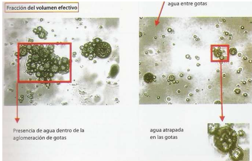
Figura No. 27: diferentes condiciones del agua en una emulsión; fuente SFERB
