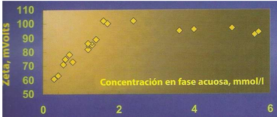
Figura No. 22: gráfica que muestra cómo el potencial electrocinético del asfalto varía con la concentración del emulsificante catiónico cuando está en equilibrio; fuente SFERB
