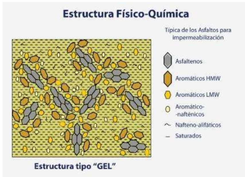
Figura No. 6: fisicoquímica del asfalto tipo gel; fuente Repsol®
