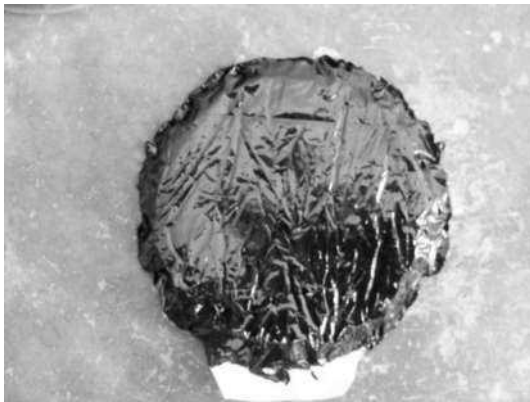
Fotografía No.47: emulsión asfáltica estándar para ser analizada por MEB; fuente propia
