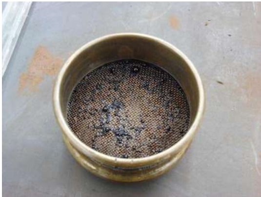
Fotografía No.25: prueba de retenido en la malla No. 20 del residuo de la emulsión; fuente propia
