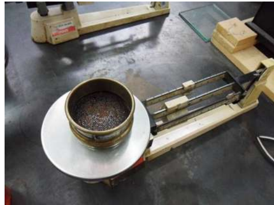
Fotografía No.26: pesando la malla No. 20 con el residuo de emulsión; fuente propia
