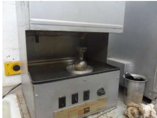
Fotografía No. 22: prueba de viscosidad Saybolt Furol; fuente propia
