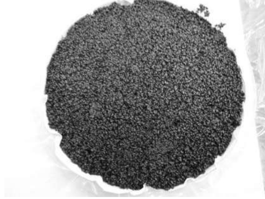
Fotografía No.46: mezclas asfáltica modificada para ser analizada por MEB; fuente propia
