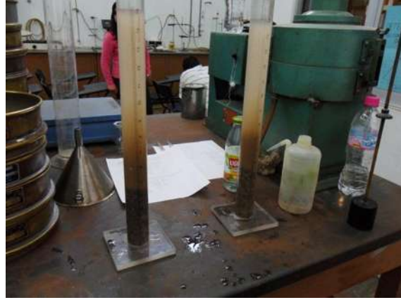
Fotografía No. 36: probetas agitadas en la prueba del equivalente de arena; fuente propia
