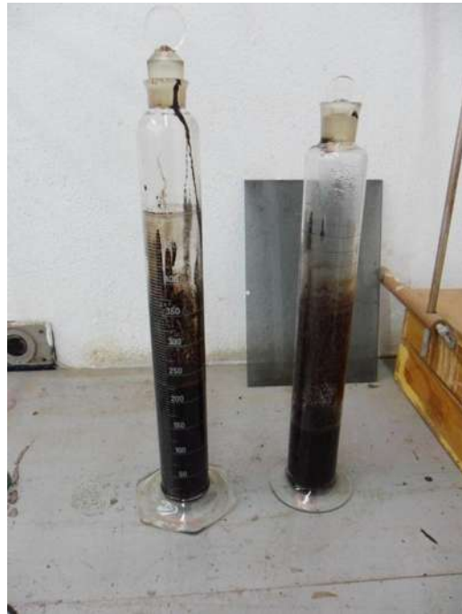
Fotografía No.24: probetas después de la prueba de asentamiento a 5 días; fuente propia
