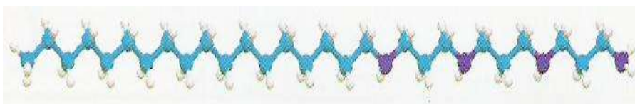
Figura No. 18: representación espacial de una polipropilen-amina de sebo; fuente SFERB
