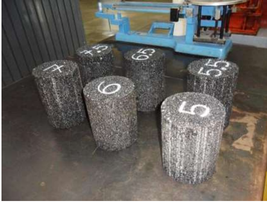
Fotografía No. 38: elaboración de pastillas de mezcla asfáltica; fuente propia
