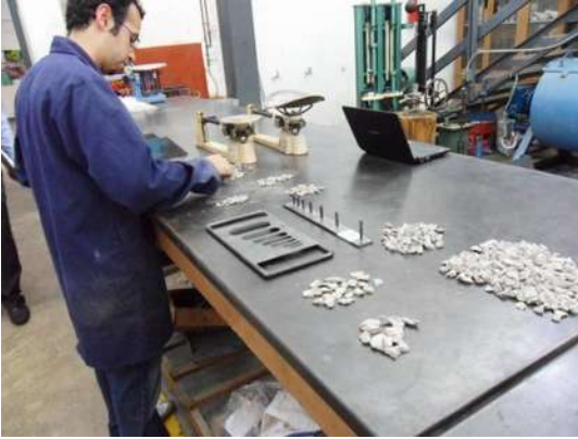
Fotografía No.33: separando las partículas por su espesor y longitud; fuente propia
