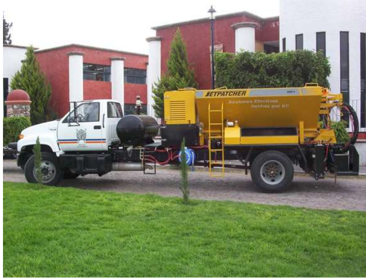
Fotografía No. 14: distribuidor de ligante con lanza aspersora y distribuidor manual de pétreos; fuente Jetpatcher
