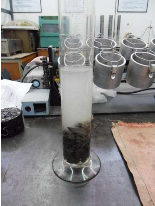
Fotografía No.29: material saturado en agua, prueba de densidad relativa; fuente propia
