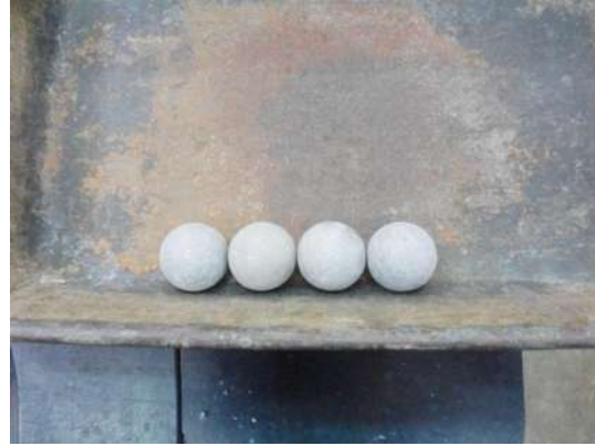
Fotografía No.32: esferas metálicas para la prueba de desgaste de los ángeles; fuente propia.
