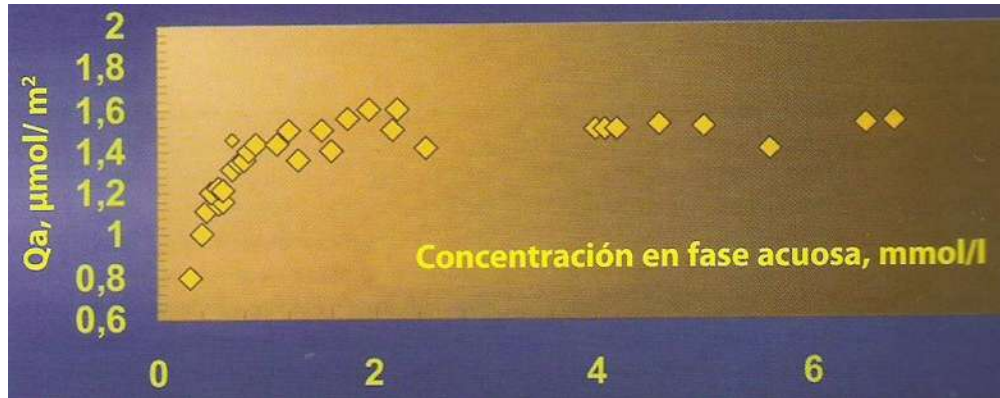
Figura No. 23: gráfica que muestra cómo la cantidad de emulsificante adsorbido varía con la concentración en la fase acuosa cuando está en equilibrio; fuente SFERB
