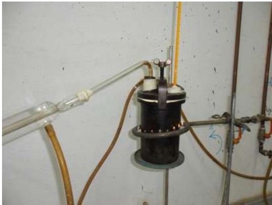
Fotografía No. 15: Prueba de destilación de emulsión asfáltica; fuente propia
