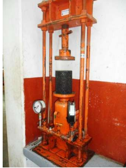
Fotografía No.41: prueba de compresión simple sin confinamiento; fuente propia
