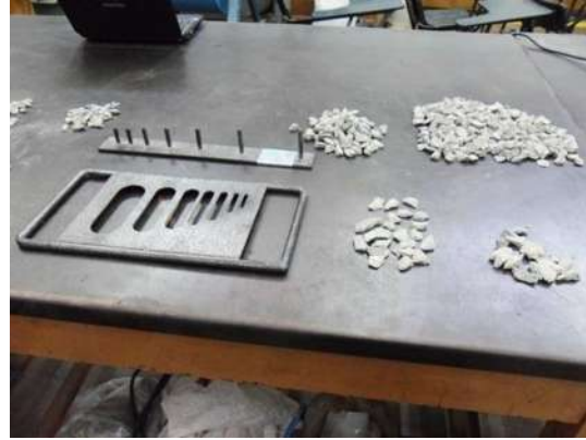
Fotografía No.34: calibradores y material pétreo en la prueba de partículas alargadas y lajeadas; fuente propia
