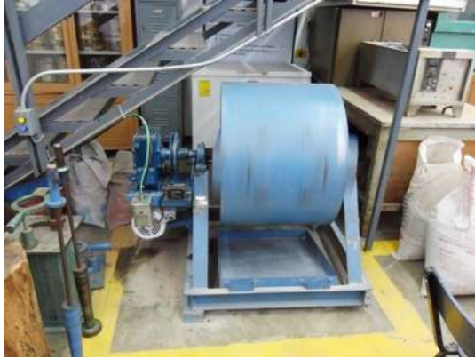
Fotografía No.31: equipo para la prueba de desgaste de los ángeles; fuente propia
