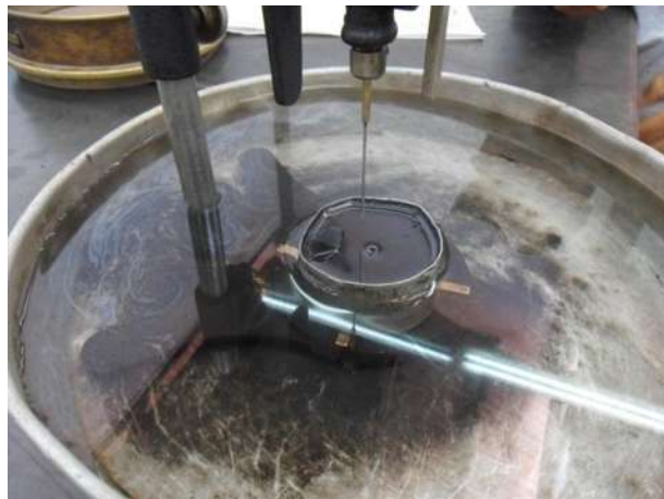
Fotografía No. 18: prueba de penetración a residuo asfáltico; fuente propia
