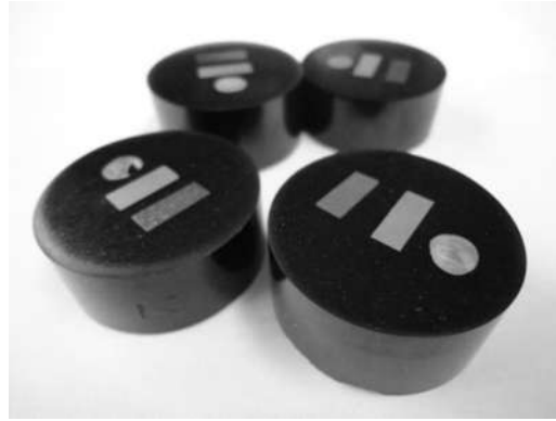
Figura 2. 4 Probetas sumergidas en resina, microestructura equiaxial contigua a referencia redonda.
