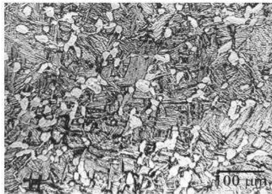
Figura 1. 9 Estructura bimodal en Ti-6Al-4V [13].
