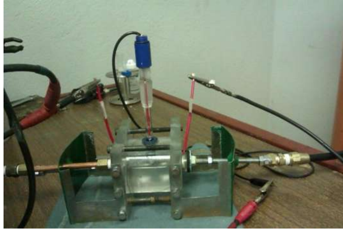
Figura 2.11. Celda electroquímica utilizada para las mediciones de ruido electroquímico.
