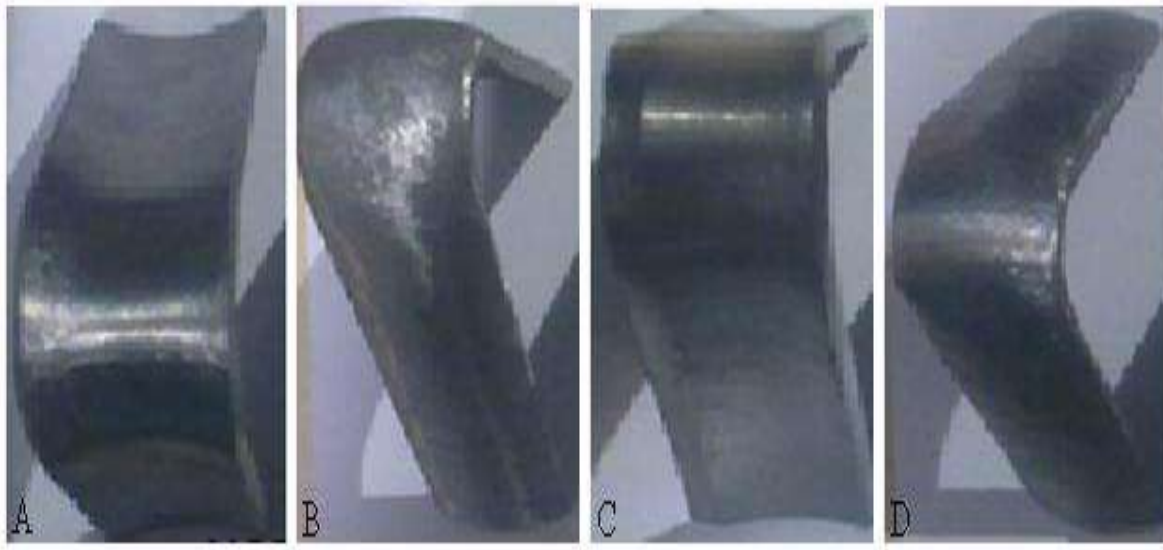
Figura 3.15: Probetas después de ser sometidas al ensayo de doblez guiado. A) Dobleza de raíz 60°, B) Dobleza de cara 60°, C) Dobleza de raíz 75°, D) Dobleza de cara 75°.
