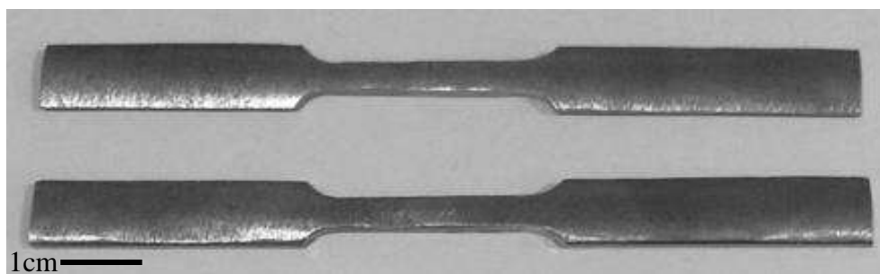
Figura 2.7. Probetas para el ensayo de tensión.
