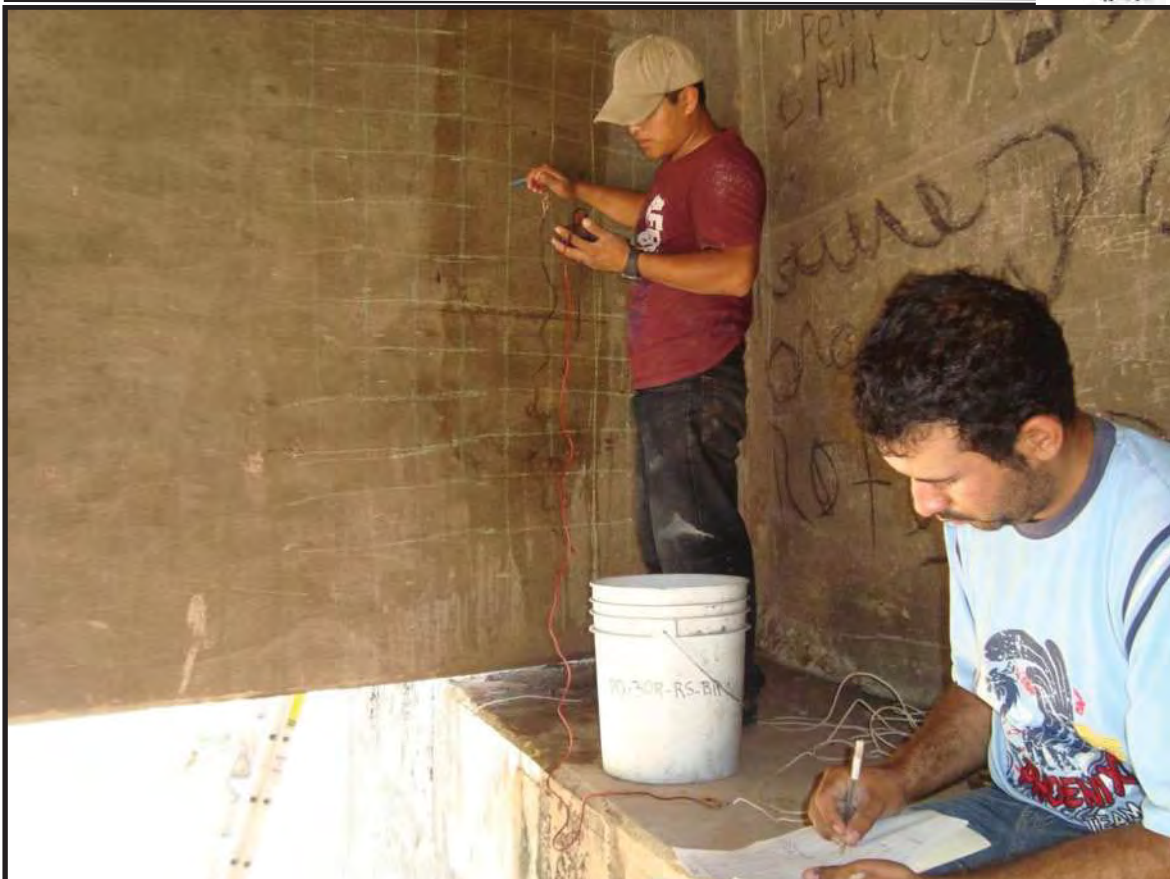
Foto VII.11 Ejemplo de Medición de Potenciales de la Trabe del Puente “El Rangel”, Lázaro Cárdenas. (03/JUN/2011).
