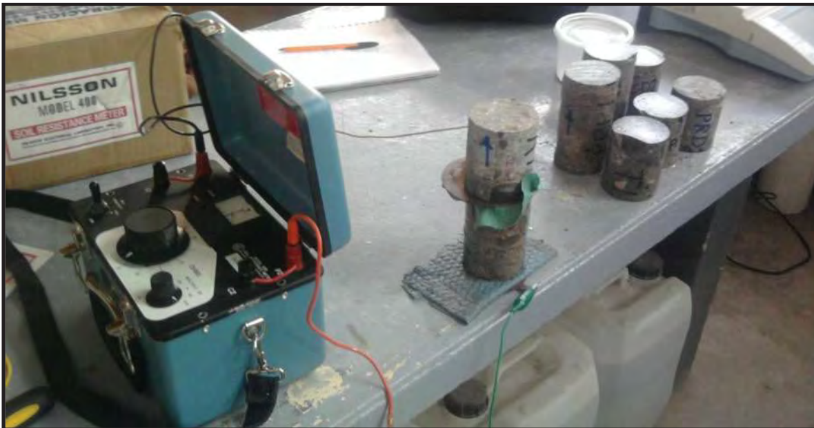
Foto VII.2 Ejemplo de Prueba de Resistividad Eléctrica.
