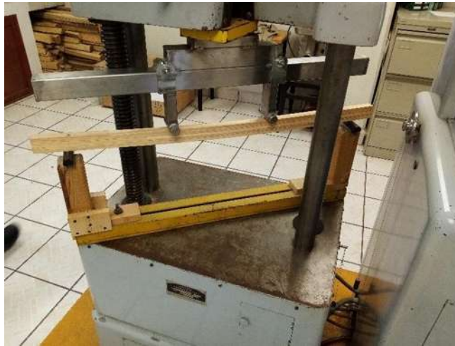
Figura 51. Pruebas de flexión a probetas de madera, realizadas en la prensa universal del laboratorio de pruebas físicas de la facultad de Ingeniería en Tecnología de la Madera, UMSNH.
