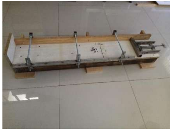
Figura 45. Prensa transversal para el pegado de las láminas que conformaron la probeta, elaboración propia
