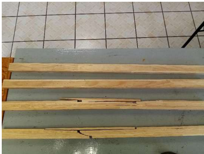
Figura 52. Probetas ensayadas de ambos tipos de vigas de madera de Pino. Elaboración propia.
