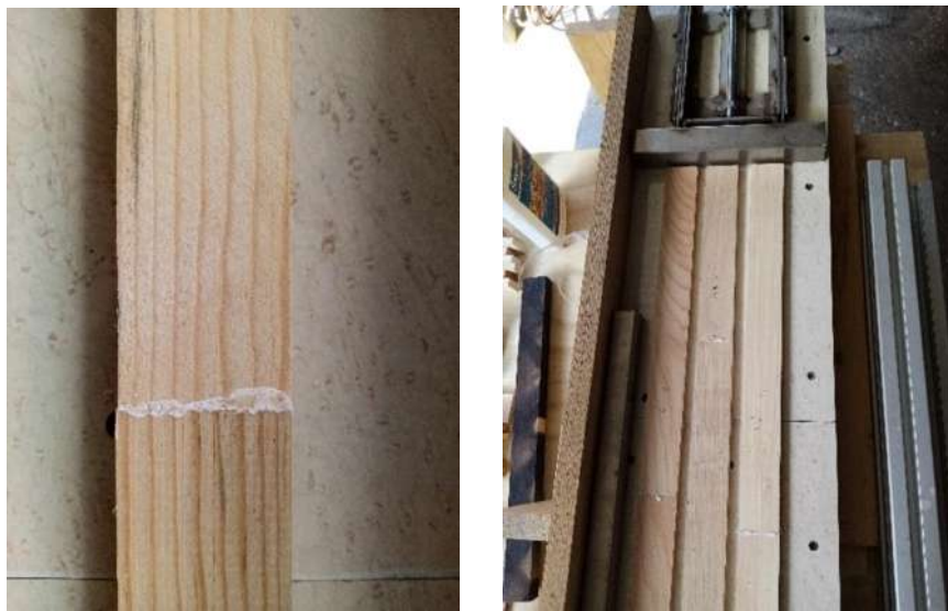
Figura 44. Izq. unión a tope de las piezas para fabricar la lámina, der. Mesa de prensado para la fabricación de las láminas. Elaboración propia.
