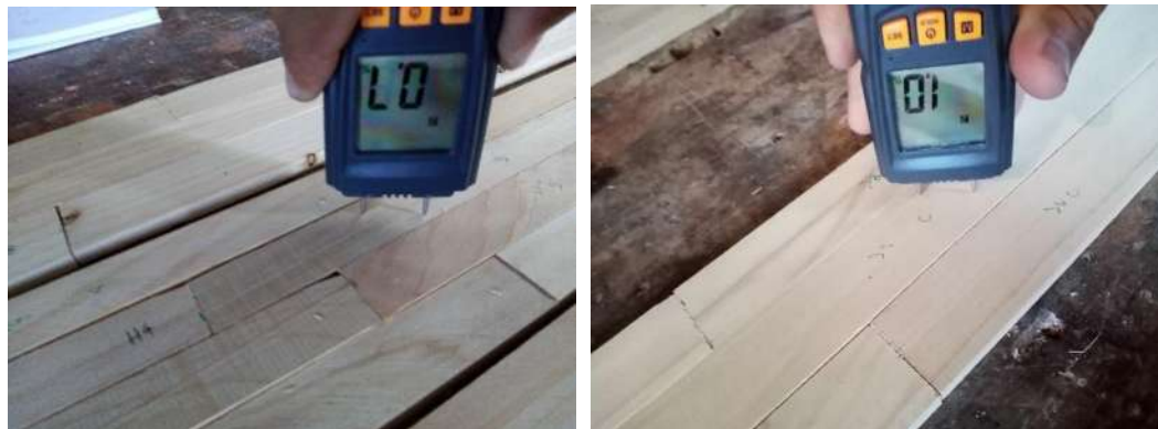
Figura 46. Toma de medidas de la laminas antes de la conformación de las probetas, elaboración propia.
