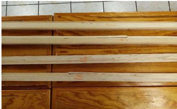
Figura 53. Probetas ensayadas de ambos tipos de vigas de madera de Cedro Blanco. Elaboración propia.
