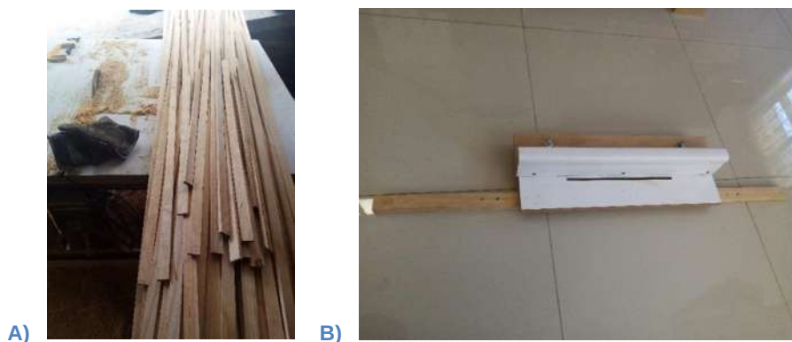
Figura 38. A) Corte de la madera en tiras para fabricación de láminas, B) Dispositivo para corte de tiras para la fabricación de las láminas, imágenes propias.
