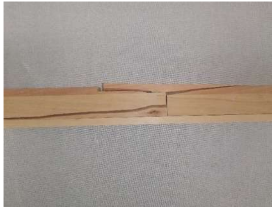
Figura 55. Falla por desviación de la fibra en ambas especies de las probetas. Elaboración propia.
