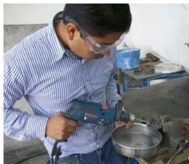
Figura N°35. Obtención de polvo de las muestras (Fuente M.A Navarrete Seras).
