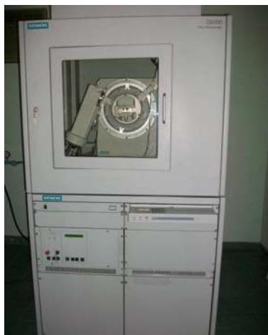
Figura N°38. Equipo para realizar la prueba de difracción de rayos X (Fuente M.A Navarrete Seras).
