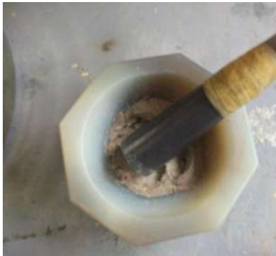
Figura N°36. Mortero de Agata con el polvo de la muestra (Fuente M.A Navarrete Seras).
