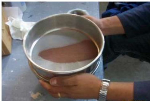
Figura N°37. Cribado del polvo mediante malla N° 200 (Fuente M.A Navarrete Seras).
