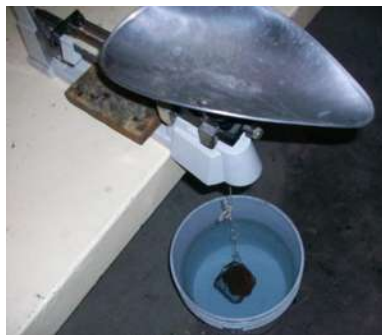
Figura N° 23. Determinación de la gravedad específica ( Fuente M. A. Navarrete Seras ).
