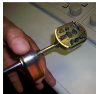
Figura N°33. Portamuestras donde se observan las diez muestras (Fuente M.A Navarrete Seras).
