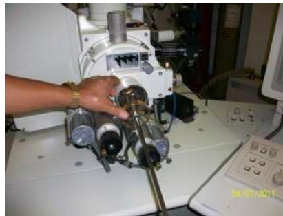
Figura N°32. Extracción del tren de portamuestras (Fuente M.A Navarrete Seras).
