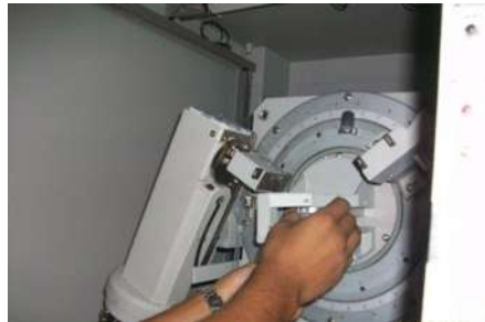
Figura N°41. Colocación de la muestra en el equipo (Fuente M.A Navarrete Seras).
