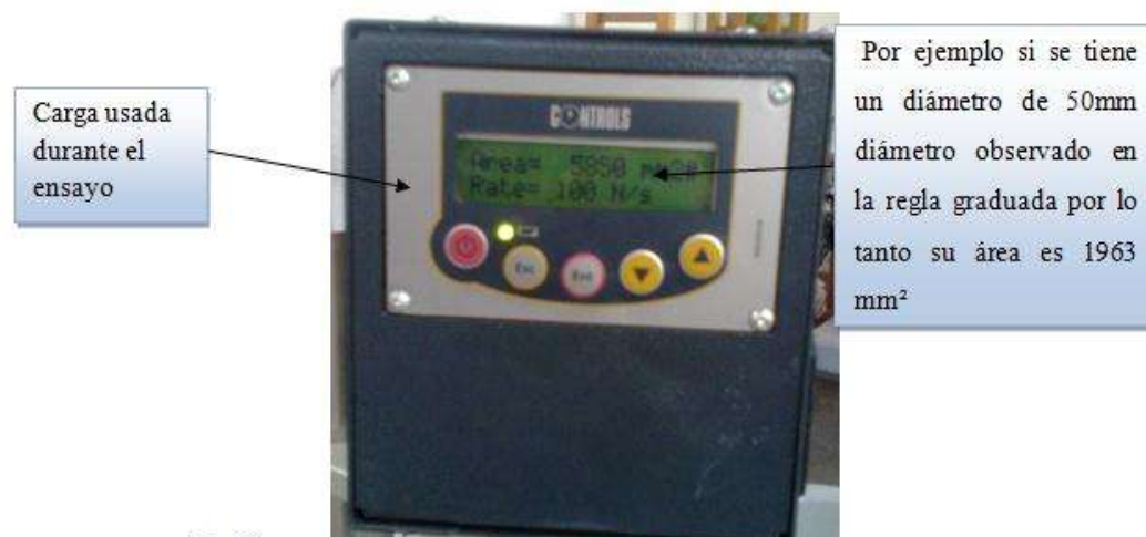
Figura N°43. Datos que se deben introducir antes de comenzar la prueba al manómetro digital (Fuente M. A. Navarrete Seras).
