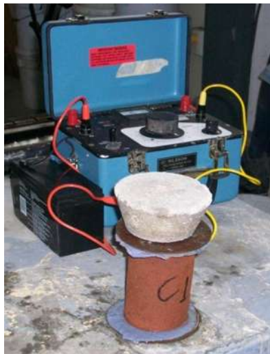
Figura N°51. Equipo de resistividad, en la imagen se observa cómo se realiza la resistividad de la muestra C1 (Fuente M. A. Navarrete Seras).
