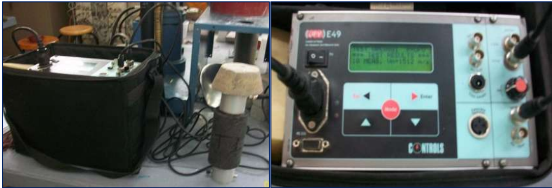
Figura N°52. Equipo de ultrasonido, determinando la V_p en la muestra T1 (Fuente M. A. Navarrete Seras).
