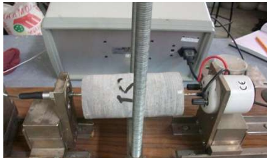
Figura N°54. Punto nodal al centro del largo de un cilindro en este caso se observa la muestra S1 perteneciente al banco El Colegio (Fuente M. A. Navarrete Seras).
