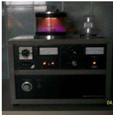
Figura N°29. Metalizadora S150A SPUTTER COATER (Fuente M. A. Navarrete Seras).
