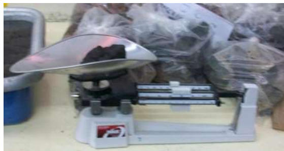
Figura N°22. Determinación del peso seco de la muestra (Fuente M. A. Navarrete Seras).
