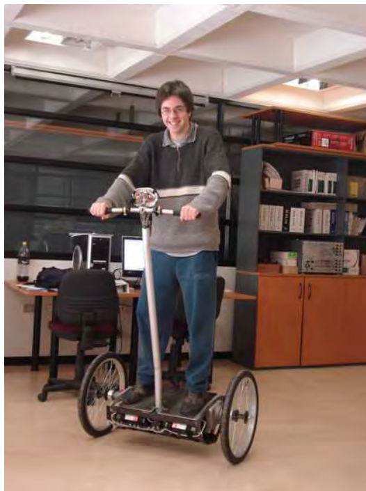
Figura 1.7: Vehículo auto-balanceado sobre dos ruedas [Moreno 2009]
