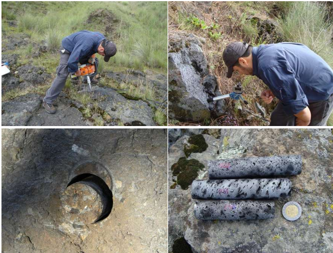
Figura 13: Muestreo en campo. Obtención de las muestras: perforación, orientación.
