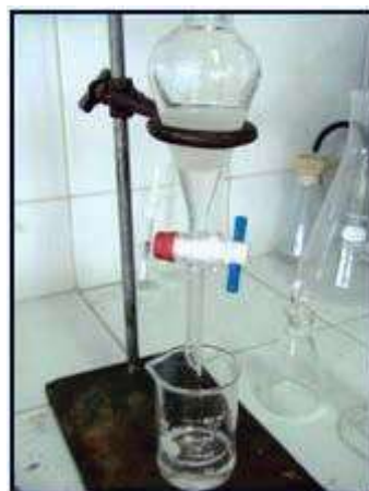
Fig. 26 Recuperación de la fase orgánica.
