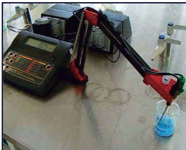
Fig. 16 Preparación de la mezcla y medición de pH en el grupo VI.
