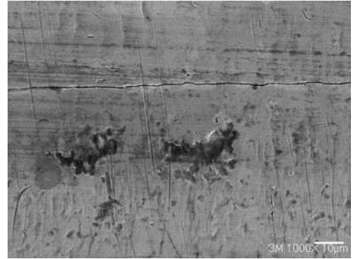
B1 Muestra la micrografía tomada por el MEB a una magnificación de 1000X indicado la mayor existencia de grietas e impurezas de la marca 1.
