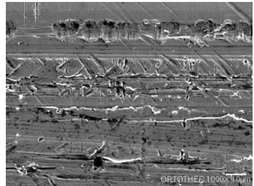
B9 Muestra la micrografía tomada por el MEB a una magnificación de 1000X indicado la mayor existencia de impurezas y la presencia de grietas más amplias y profundas de la marca 9.
