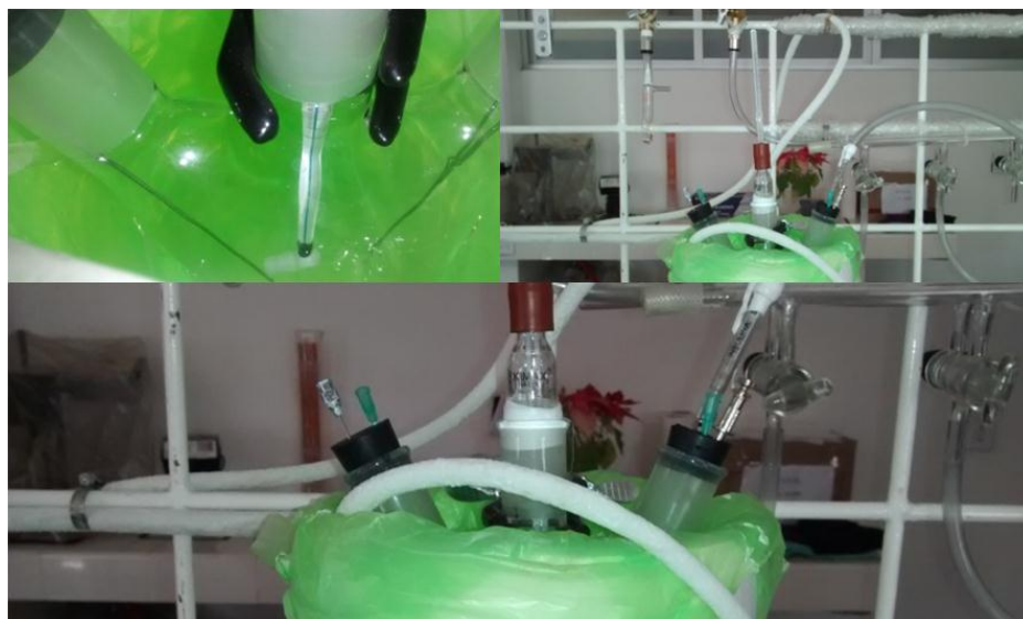
Fig. 3.3 Reactor de polimerización aniónica mediante atmosfera inerte a -15^{\circ}\text{C} .
