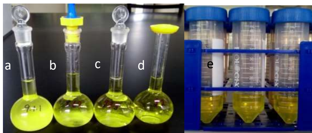
Figura 4.6 Digestión asistida mediante horno de microondas: a) AR, b) AR + 1 mL HF, c) AR + 1.5 mL HF, d) AR + 2 mL HF y e) serie de muestras con digestión completa
