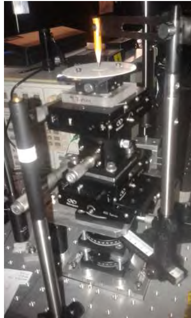
Figura 14. Vista de la sección principal del dispositivo experimental mostrando la técnica para determinar el eje de giro.
