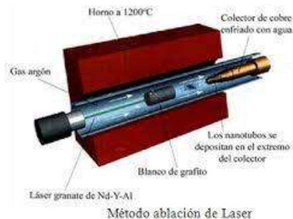
Figura 2.10. Diagrama del proceso de Ablación Láser.
