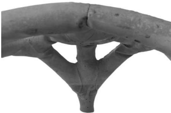
Figura 79: Pliegue en modelo de concreto, elaboración propia.
