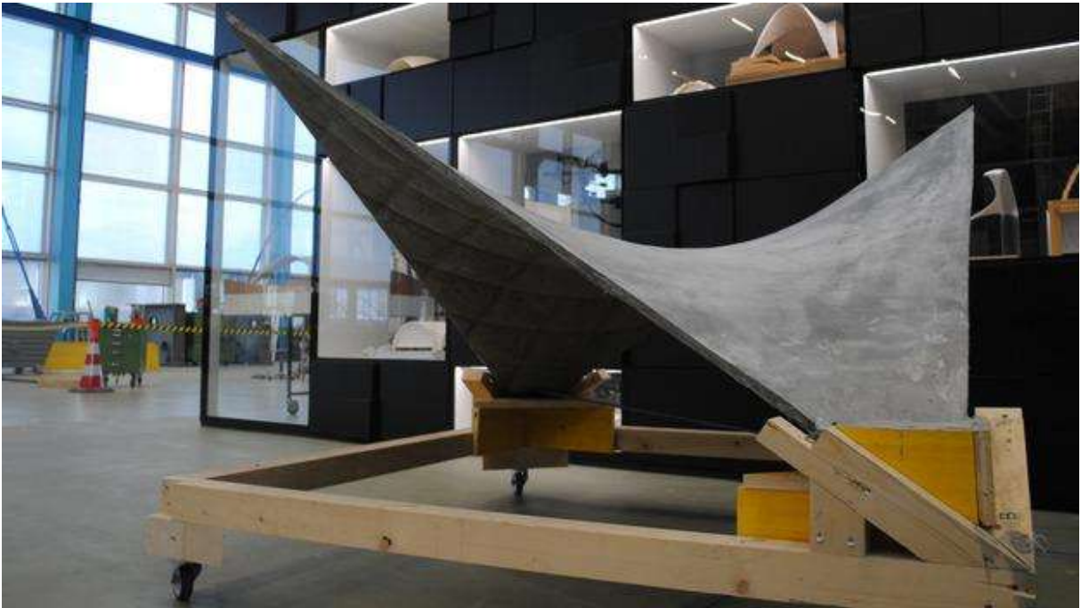
Figura 14: Shell parábola hiperbólica Phillippe Block (R. G. B. 2018).
