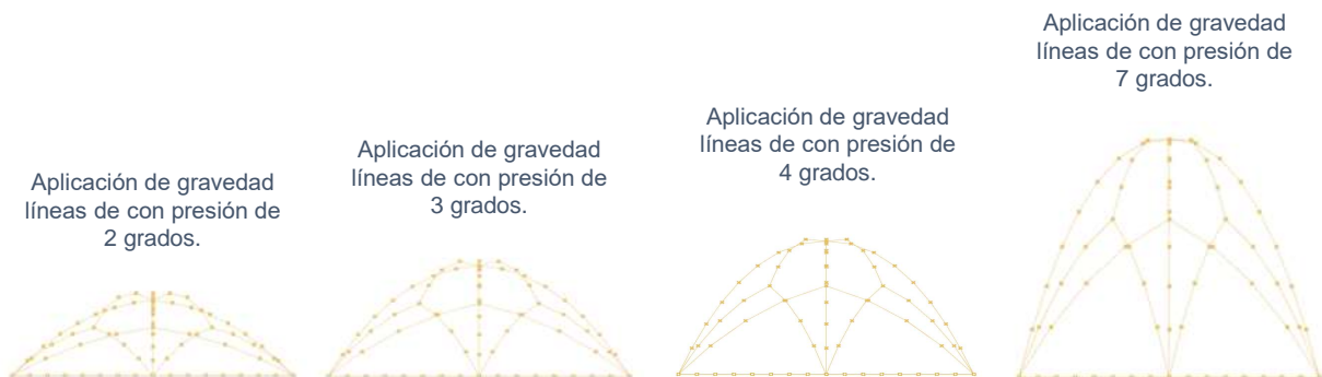
Figura 81: Diagrama de alturas de forma propuesta simulada en el software Rhino 7®, elaboración propia.
