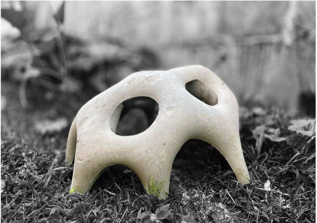
Figura 102: Modelo final de concreto creado mediante la técnica de diseño de form finding, elaboración propia.
