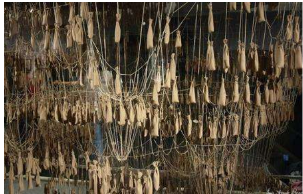
Figura 05: Modelo catenario de la Sagrada Familia. Gaudí A. 1888.
