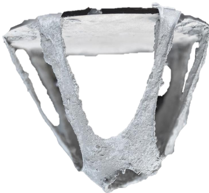
Figura 64: colado de la cimbra textil, elaboración propia.
