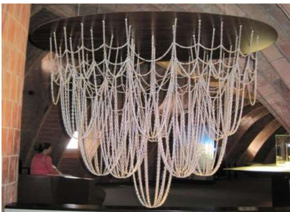
Figura 06: Modelo con cadenas en relajación. Gaudí, 1963.
