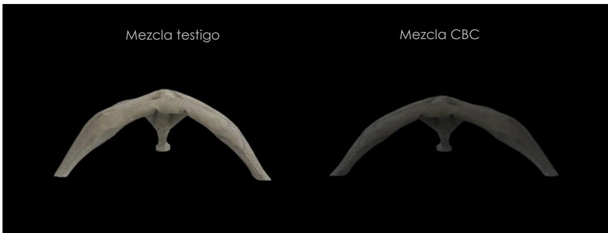
Figura 78: Forma final del concreto convencional y con puzolana en cimbra textil en relajación por el método de diseño de form-finding, elaboración propia.
