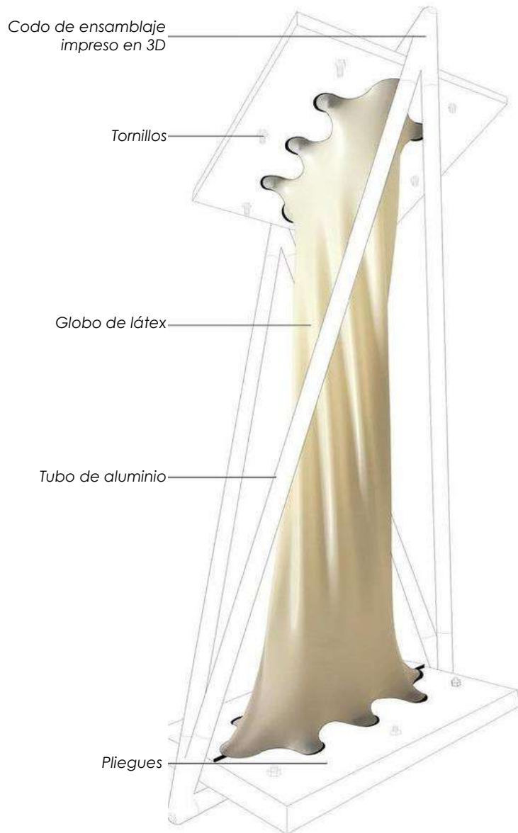
Figura 18: Cimbra de látex final. Mehdizadeh, 2018.
