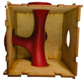
Figura 44: Cimbra de látex, elaboración propia.
