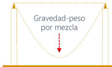
Figura 62: dirección de las fuerzas tensoras, elaboración propia.
