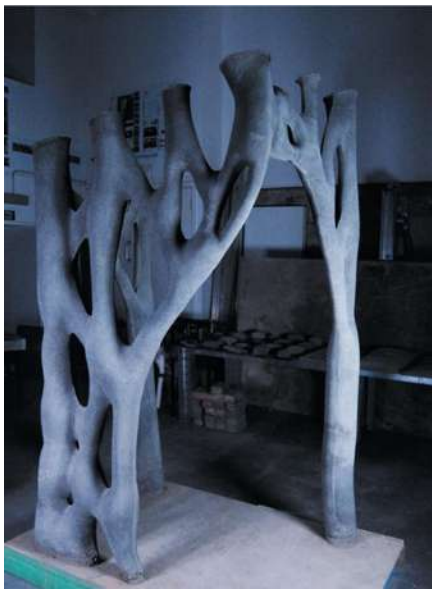
Figura 23: afectación del material en cimbra textil. Universidad de Michigan, 2015.
