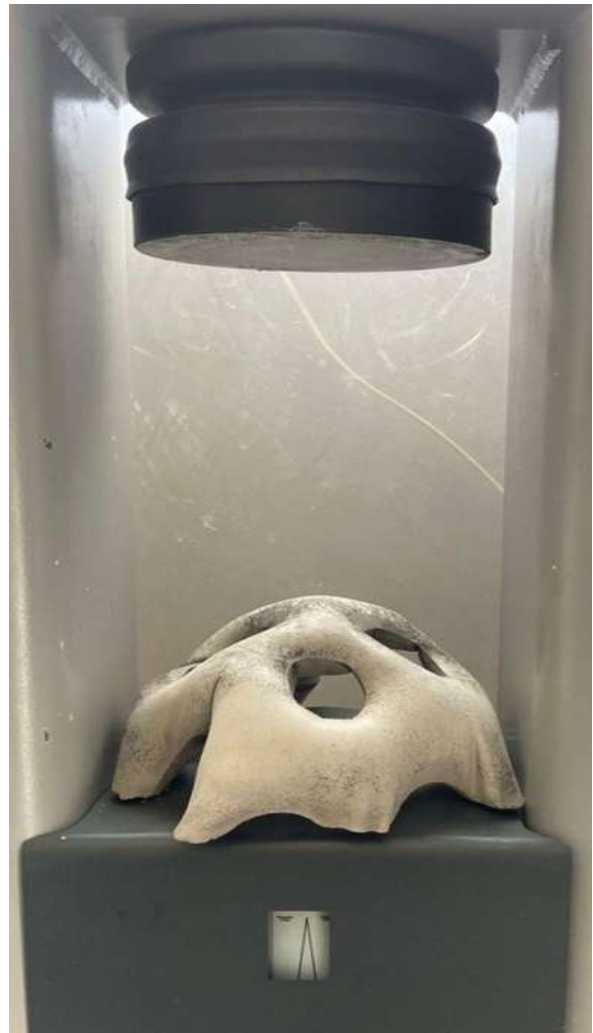
Figura 100: Propuesta de prueba destructiva en carga a compresión, elaboración propia.
