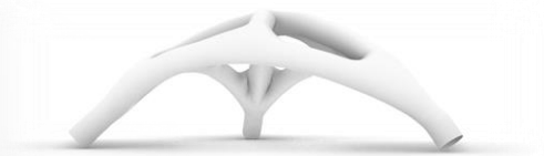
Figura 73: dirección de las fuerzas tensoras, elaboración propia.
