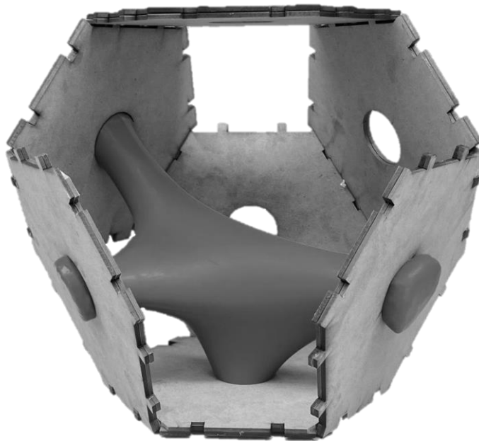
Figura 55: Cimbra de estructura interna de látex en proceso de fraguado, elaboración propia.
