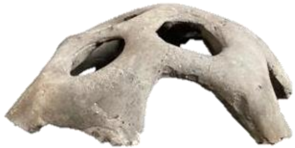
Figura 94: Modelo descimbrado a la edad de 24 horas, elaboración propia.
