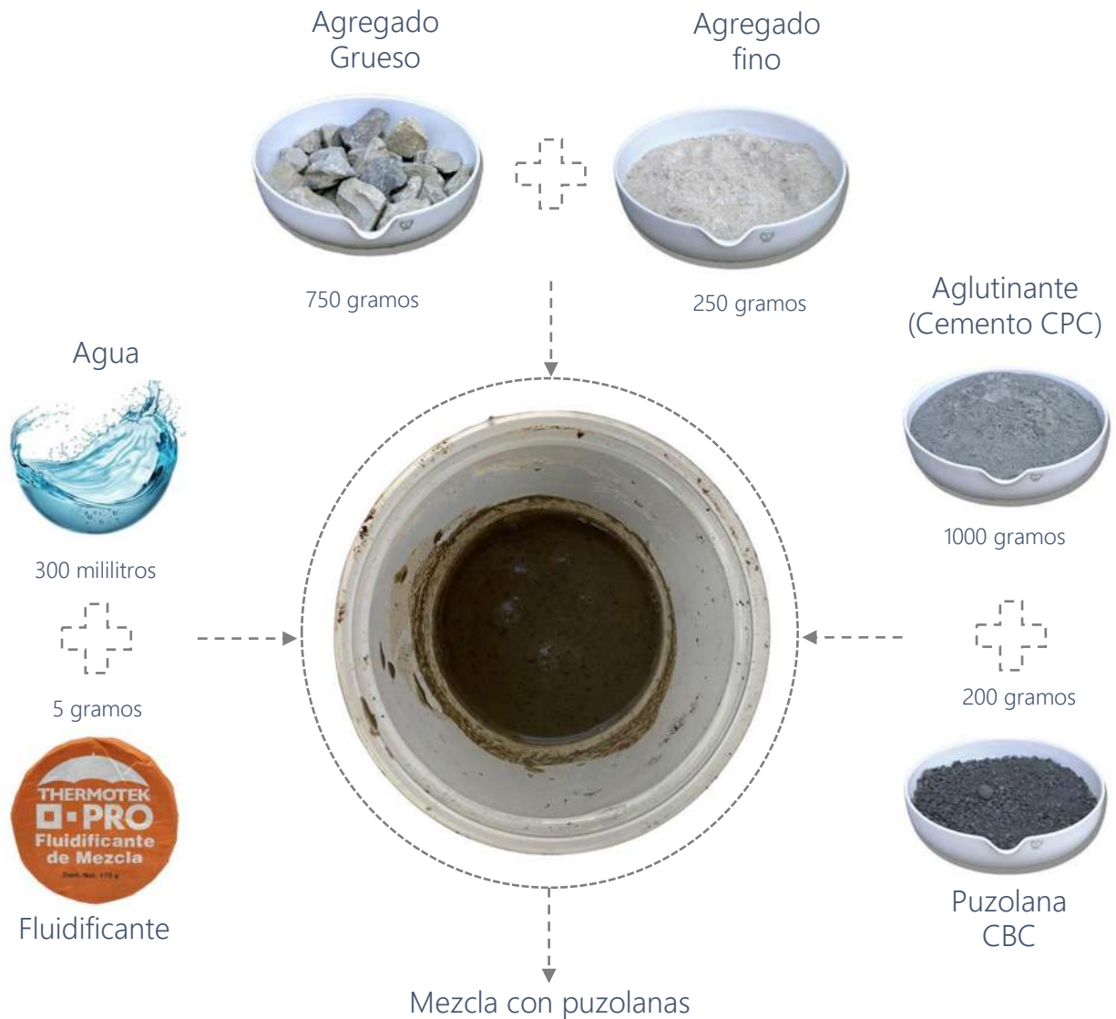
Figura 26: Diagrama de composición de la mezcla de concreto con adición puzolánica, elaboración propia.
