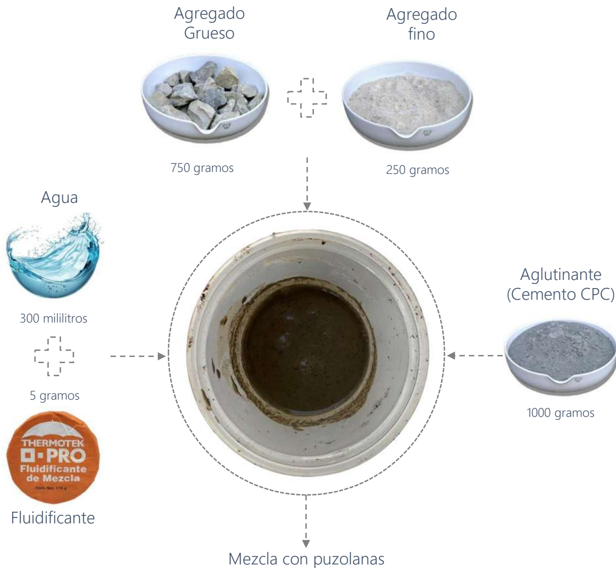
Figura 25: Diagrama de composición de la mezcla de concreto, elaboración propia.
