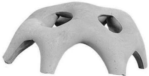
Figura 95: Modelo descimbrado a la edad de 7 días, elaboración propia.
