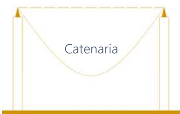
Figura 61: formación de catenaria, elaboración propia.
