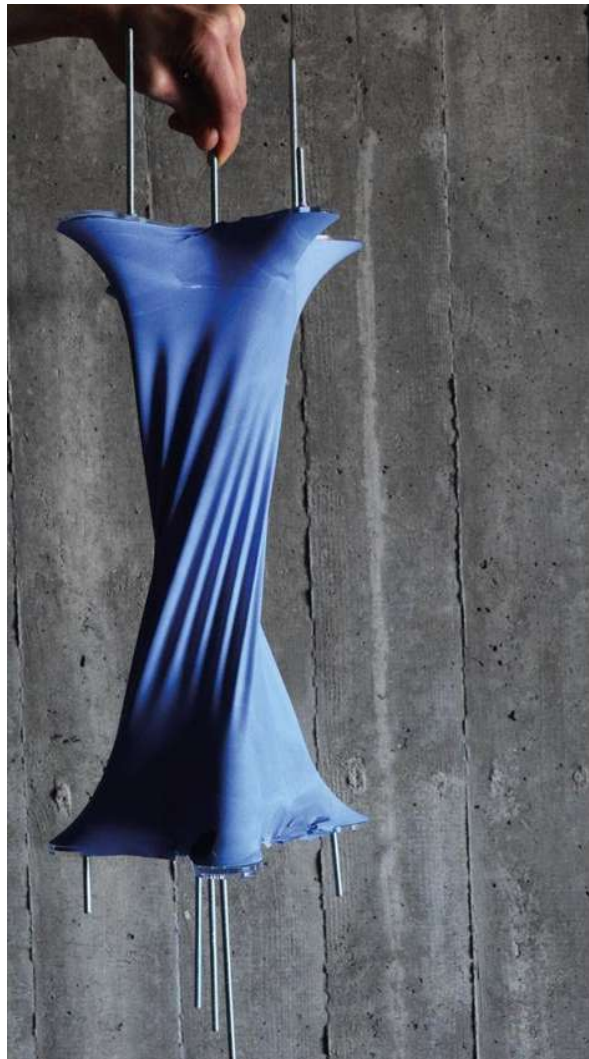
Figura 15: colado de cimbra de látex (Mehdizadeh, 2018).
