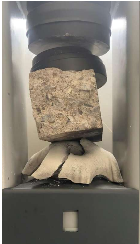
Figura 101: Destrucción por compresión de modelo de concreto, elaboración propia.
