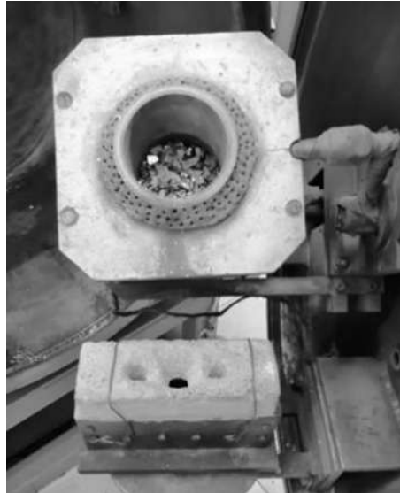
Figura 3.6 Crisol con carga metálica y molde dentro del horno de inducción al vacío.
