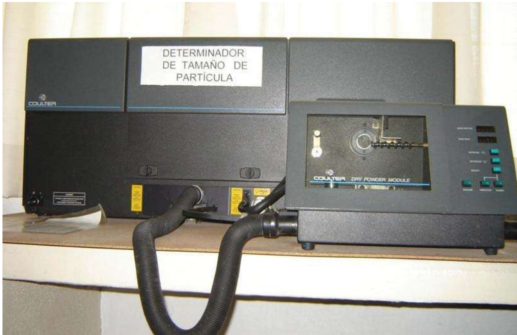
Figura 12: Determinador de tamaño de partícula Coulter LS 100Q.
