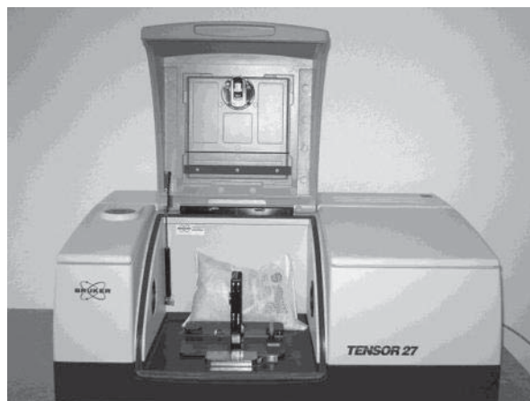
Figura 15: Espectrómetro de Infrarrojo marca Bruker, modelo Tensor 27.
