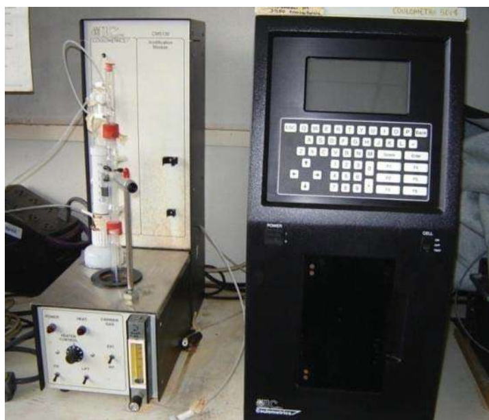
Figura 13. Coulómetro Marca UIC, Modelo S014
