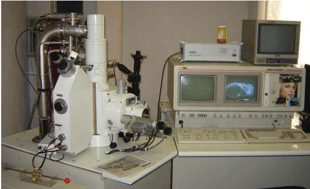
Figura 16: Microscopio electrónico de barrido, marca Bruker modelo JSM-6400.
