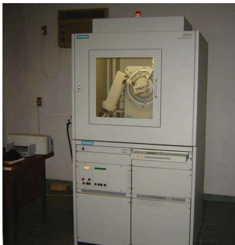
Figura 14. Difractómetro, Modelo D5000, Marca Siemens.
