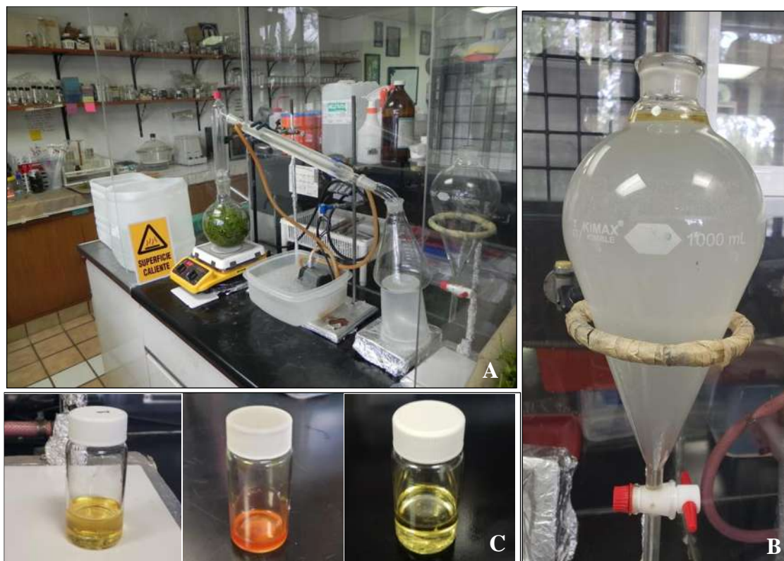
Figura 9. Obtención de aceites esenciales. A , Hidrodestilador tipo Clevenger; B , Embudo de separación; C , Aceites esenciales de las tres especies de Tagetes .
