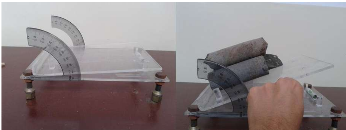
Figura 3.29. Obtención del ángulo de fricción básico en testigos.
