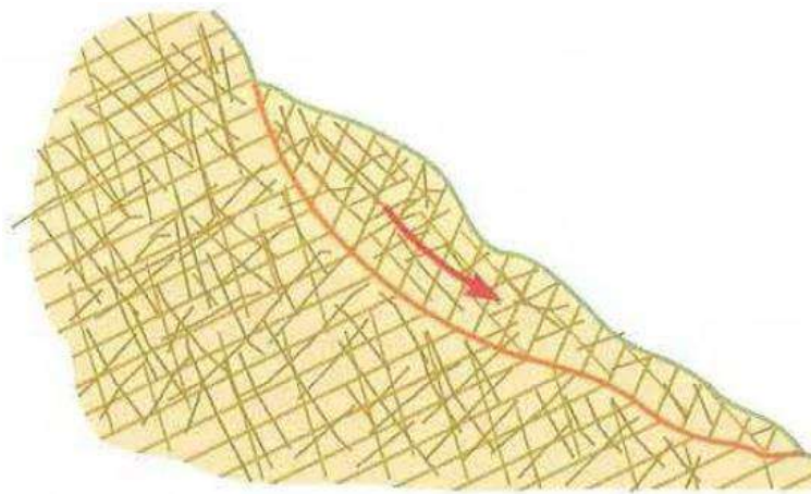
Figura 2.14. Rotura curva (González Vallejo, et al., 2002).
