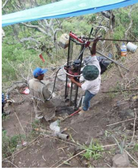
Figura 3.7. Máquina tipo Winkie utilizada para los sondeos geotécnicos.
