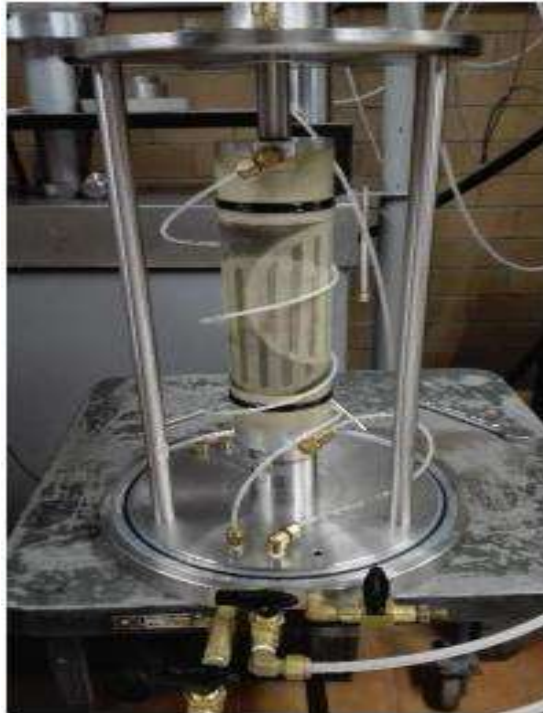
Figura 5.1: Montaje de probeta de suelo en cámara triaxial (Lerma 2017).
