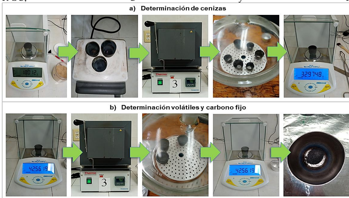
Figura 7. Análisis proximal. a) determinación de porcentaje de cenizas: pesada de muestra, calcinación, introducción a mufla (a 550 \pm 5 °C por 90 min), enfriamiento en desecador y pesada del residuo. b) determinación de materia volátil: pesada de muestra, introducción a mufla (a 900 \pm 10 °C por 7 min), enfriamiento en desecador, pesada del residuo y residuo obtenido.
