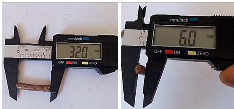
Figura 16. Determinación de longitud y diámetro de pélets.
