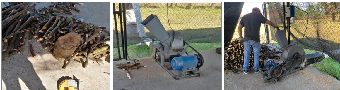
Figura 11. Reducción de tamaño de ramas. A la izquierda de la imagen: troceado de ramas con ayuda de una caladora. A la derecha: molino de matillos utilizado en la reducción de tamaño de la biomasa leñosa y parte del procesamiento.
