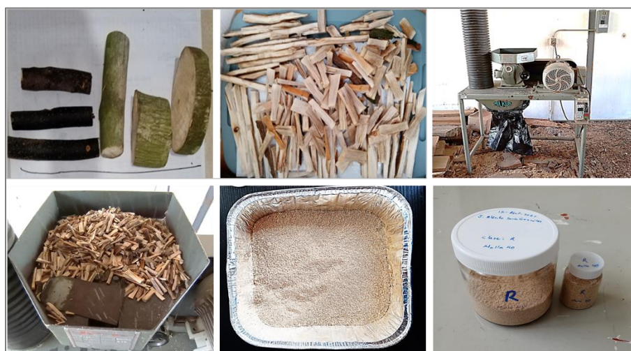
Figura 4. Preparación de muestras: clase R. Reducción de tamaño de ramas de diámetros superiores a 2.5 cm. Reducción de tamaño a astillas hasta la obtención de una harina tamizada en malla 40 (425 \mu\text{m} ).
