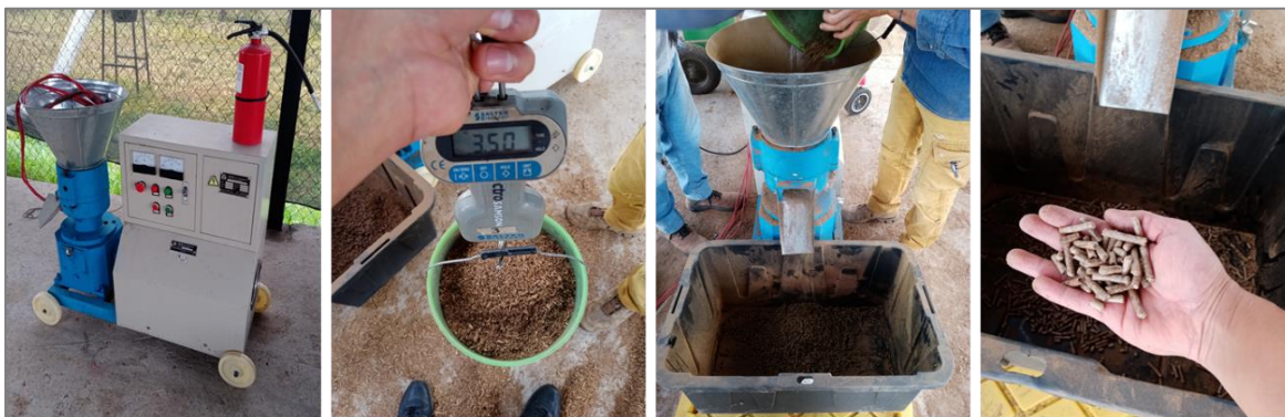
Figura 15. Proceso de peletizado. A la izquierda se muestra el equipo de peletizado empleado en el proceso. A la derecha, se muestra la pesada del aserrín con una pesola o dinamómetro, el proceso de peletizado del aserrín alimentado y una muestra de los pélets obtenidos, respectivamente.
