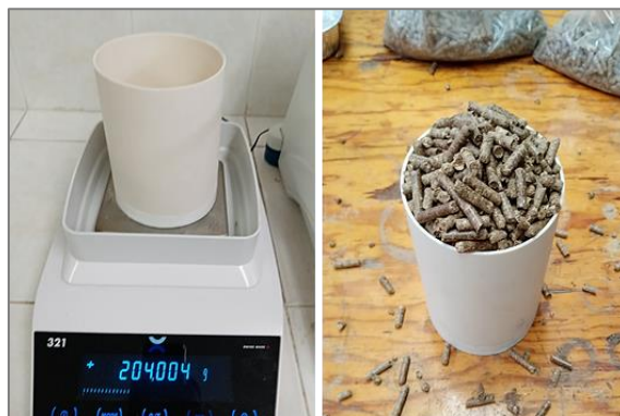
Figura 18. Determinación de densidad a granel. Se muestra el contenedor de volumen conocido empleado en los ensayos de acuerdo con la norma EN 17828 (2016).
