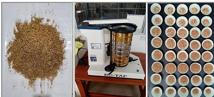
Figura 13. Distribución de tamaño de partícula por el método de tamizado según la norma EN 17827-2 (2016). En la imagen de la izquierda se observa una muestra de la biomasa utilizada para el peletizado. Al centro se muestra el equipo de tamizado empleado en los ensayos. En la imagen de la derecha se muestra la distribución por tamaños de partícula de las muestras iniciales ya tamizadas.
