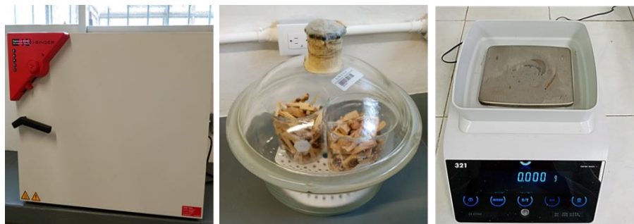
Figura 6. Determinación del contenido de humedad total de R y RPH, por el método de secado en estufa según la EN 18134-2 (2017).
