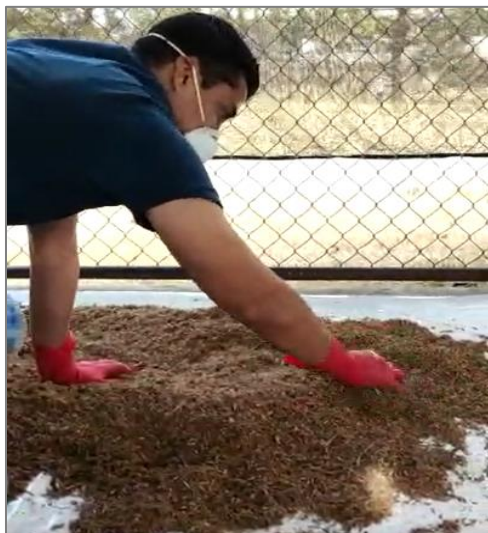
Figura 14. Mezclado de aserrín y solución de fécula de maíz sobre una manta plástica.
