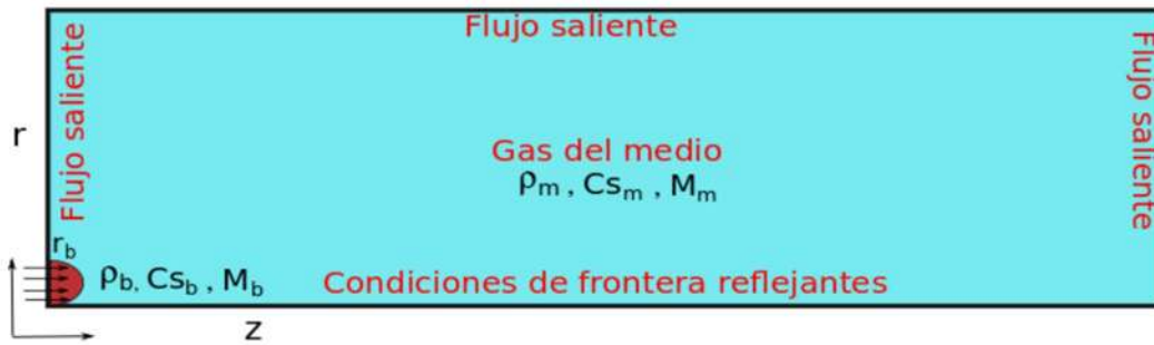
Figura 5.2: Dominio numérico y configuración inicial. Este diagrama muestra cómo se inyecta el fluido al tiempo inicial y las condiciones de frontera en cada pared.
