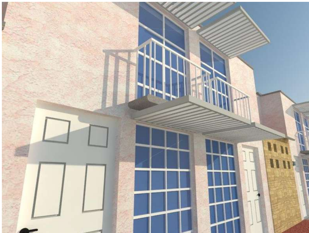
Figura V.6 Uso de dispositivos de regulación solar en ventanas ( Aleros )
