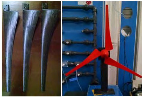
Ilustración 19. Álabes recién impresos presentando algunos detalles de imperfección (izquierda) y álabes detallados a base de lija y pintura (derecha).
