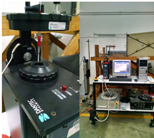
Ilustración 23. Anemómetro de hilo caliente incluyendo traverse (derecha) y equipo de calibración de probetas para probetas (izquierda).
