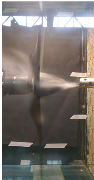
Ilustración 22. Pruebas con equipo generador de humo en rotor montado sobre motor de CD para inducir rotación.
