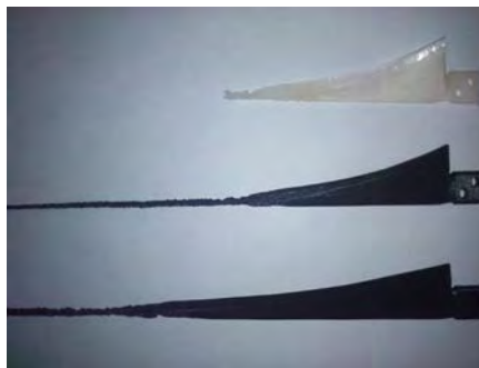
Ilustración 18. Pruebas de impresión 3D. a) \Lambda=5 (plástico PLA), b) \Lambda=5 (plástico ABS) y c) \Lambda=7 (plástico ABS).
