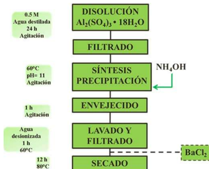
Figura 2-1. Diagrama de flujo para la síntesis de la pseudoboehmita.
