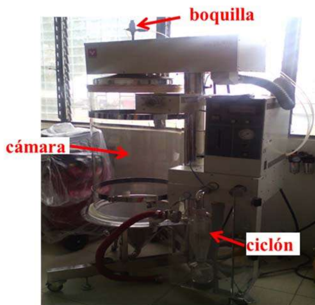
Figura 2-6. Fotografía del spray-dryer usado para el secado de los polvos precursores de los compositos.
