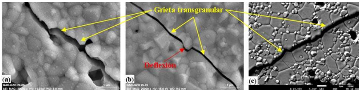
Figura 3-61. Huella de indentación en el composite GAO-GZO 20-80 (a), GAO-GZO 25-75(b) y GAO-GZO 30-70(c).
