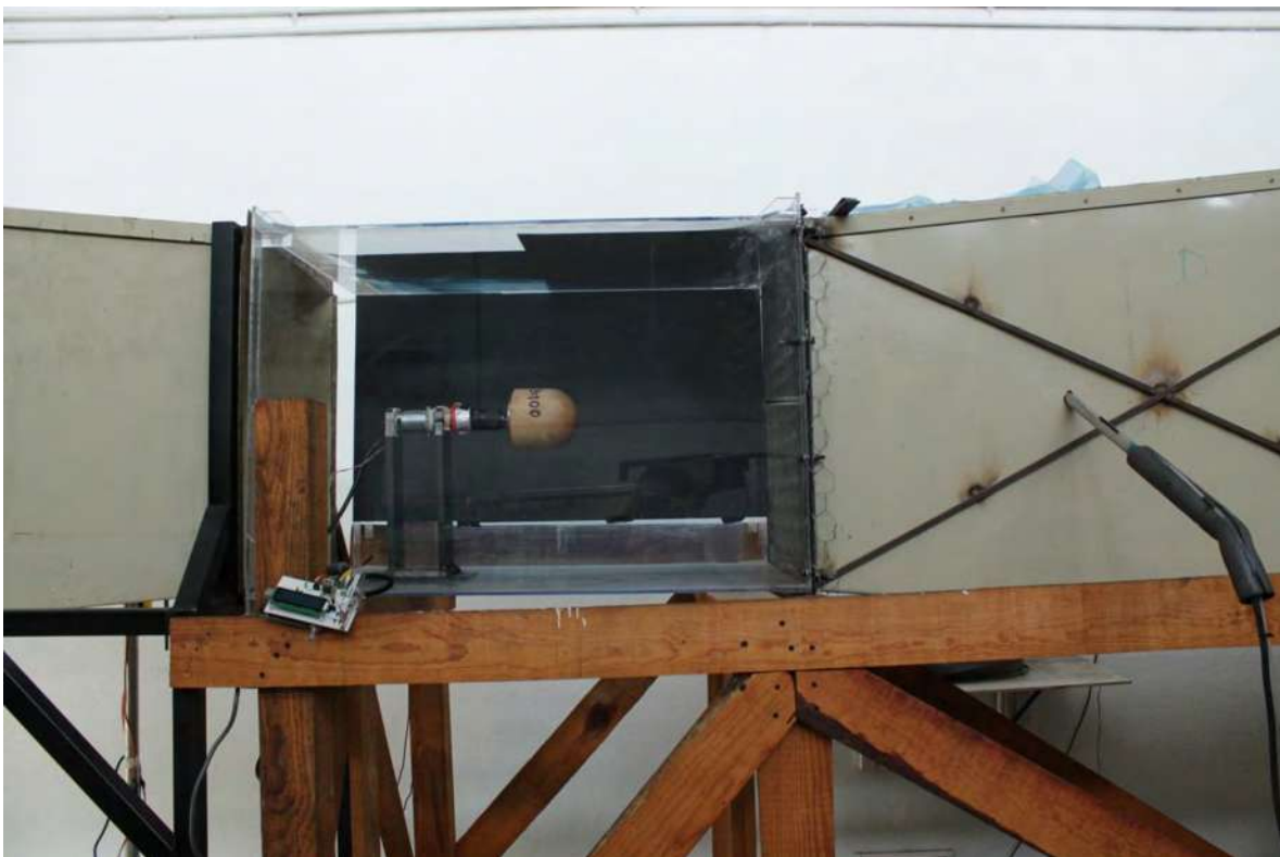
Figura- 6.27: Fotografía del túnel de viento en la cual se muestra el experimento montado, conectado a un control de velocidad para hacerlo girar a las rpm deseadas. En el lado derecho se muestra el generador de humo empleado para trazar las líneas de corriente.
