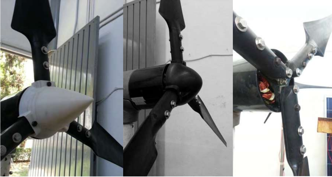
Figura- 7.45: Turbina de viento con diferentes HUB, empezando por izquierda, perfil S-C2, perfil de fábrica, sin HUB aerodinámico
