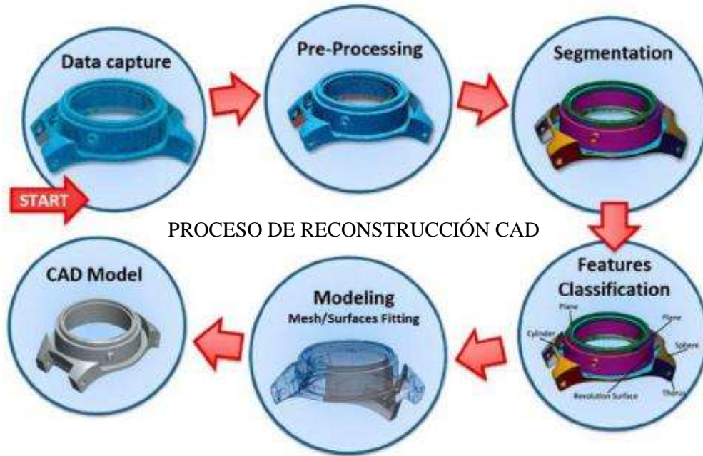
Figura 3. 1. Marco general de la reconstrucción de una pieza utilizando ingeniería inversa [27]
