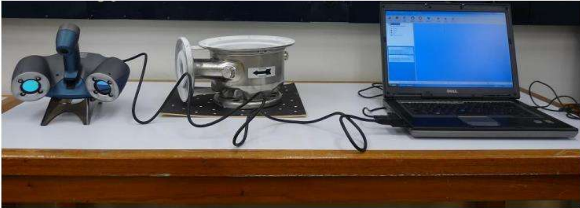
Figura 4. 3. Escaneo de la bomba con precisión de hasta 0.04 mm
