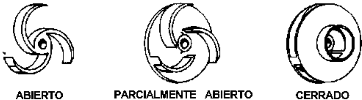
Figura 2. 4. Tipos de impulsores para las bombas centrífugas.
