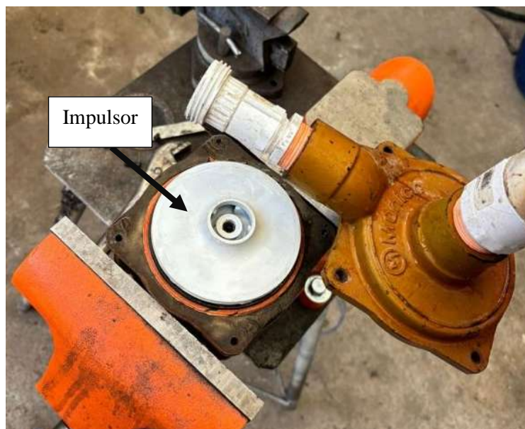
Figura 2. 3. Cuerpo hidráulico de una bomba centrífuga
