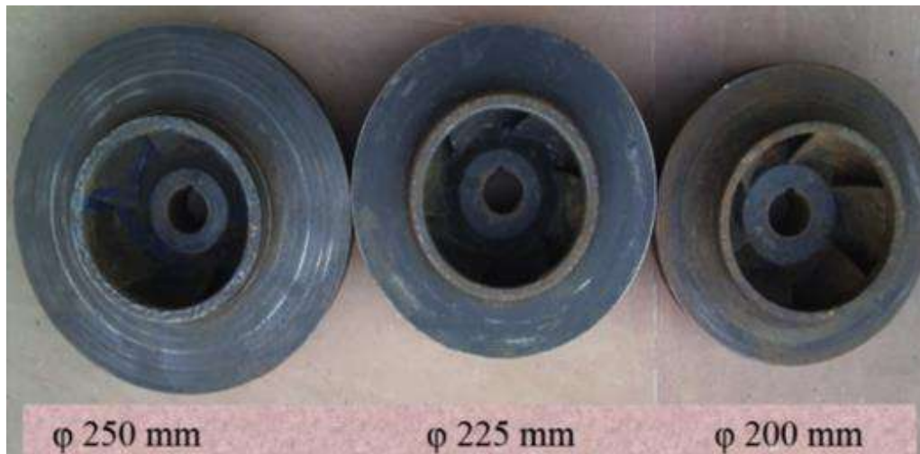
Figura 1. 5. Impulsores utilizados para las pruebas, [15]
