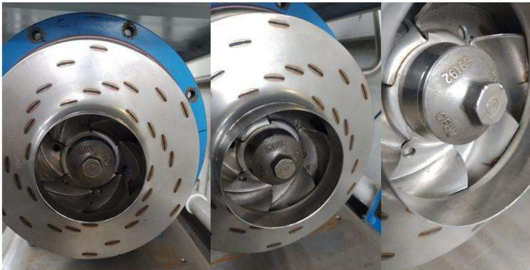
Figura 4. 5. Impulsor real montado en la bomba
