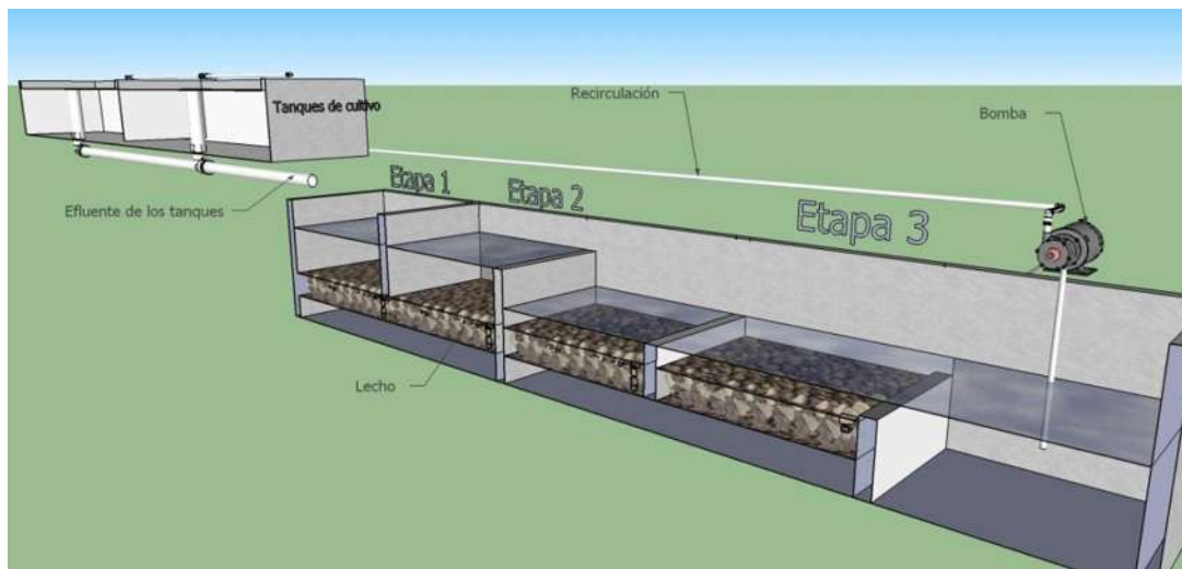
Figura 3.2 Sistema de recirculación acoplado al sistema externo de la granja acuícola de la UMSNH
