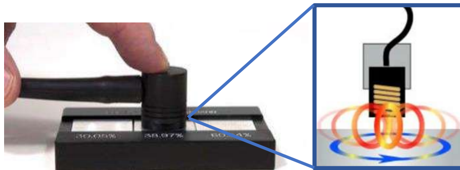
Figura 3.8 Esquema de colocación correcta de la bobina volumétrica del equipo de corrientes de Eddy sobre la muestra a inspeccionar
