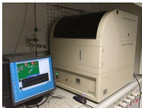
Figura 3.8. Equipo para reducción a temperatura programada con hidrógeno (TPR-H 2 )
