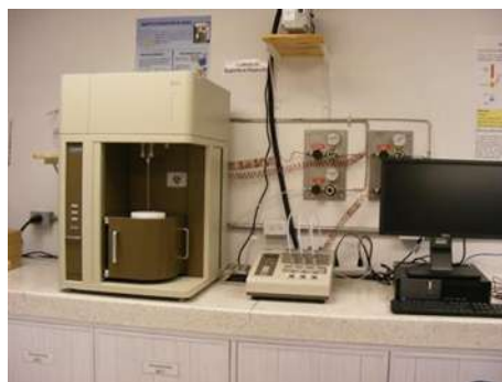
Figura 3.6. Equipo de medición de área superficial específica.
