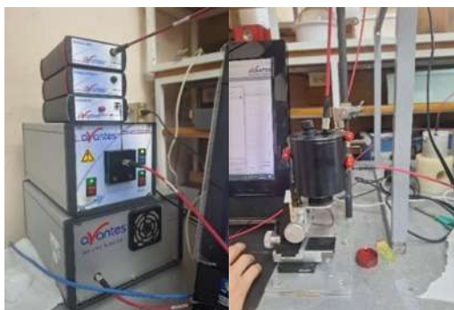
Figura 3.7. Equipo de espectroscopia UV-Vis.
