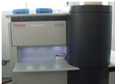
Figura 3.9. Equipo de espectroscopía de fotoelectrones de rayos X.
