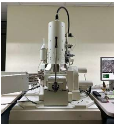
Figura 3.4. Equipo de microscopía de barrido JEOL JSM 5300.
