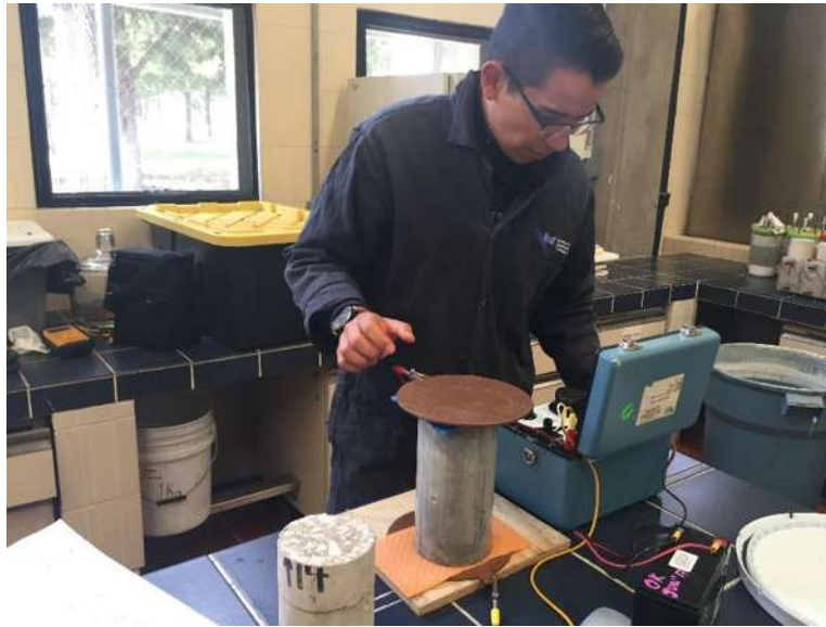
Ilustración 7. Evidencia fotográfica de la prueba de resistividad eléctrica húmeda.
