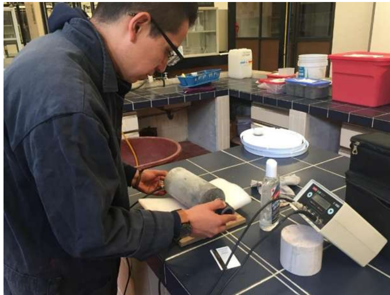
Ilustración 14. Evidencia fotográfica de la prueba de velocidad de pulso ultrasónico.
