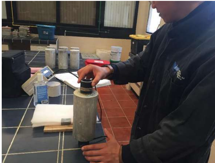
Ilustración 10. Evidencia fotográfica de la prueba de velocidad de pulso ultrasónico.
