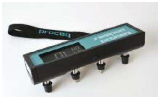
Ilustración 3. Resistivímetro tipo Wenner (Picos, 2014).
