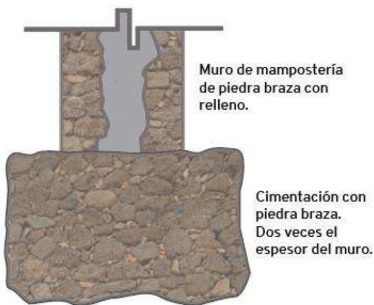
Fig. 130 Hipótesis de cimentación. Elaboración propia.
