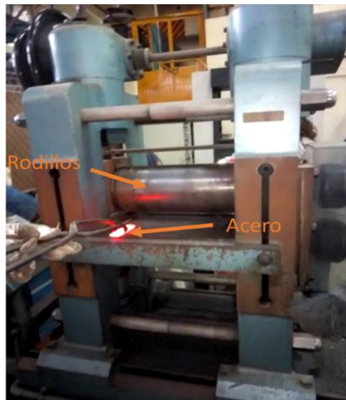
Figura 3.7. Laminación en caliente de aceros eléctricos al silicio de grano orientado.
