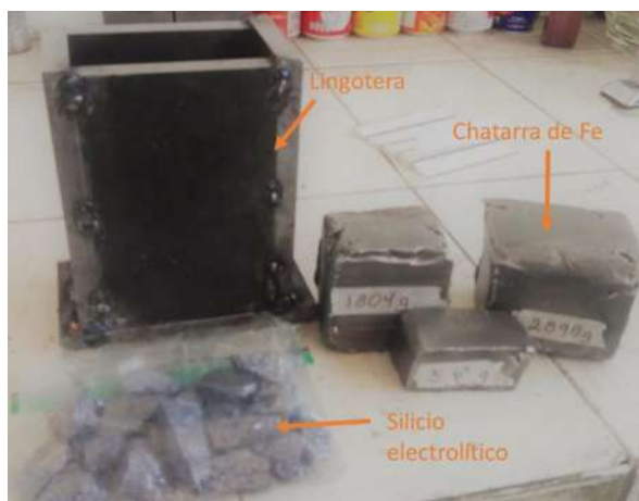
Figura 3.2. Materias primas para la fabricación de aceros eléctricos al silicio de grano orientado.
