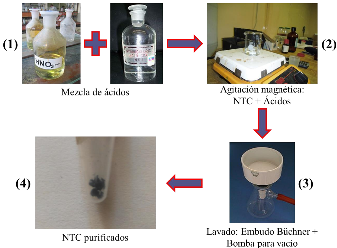
Figura 3.33. Procedimiento para la purificación de NTC empleando un tratamiento con ácidos.
