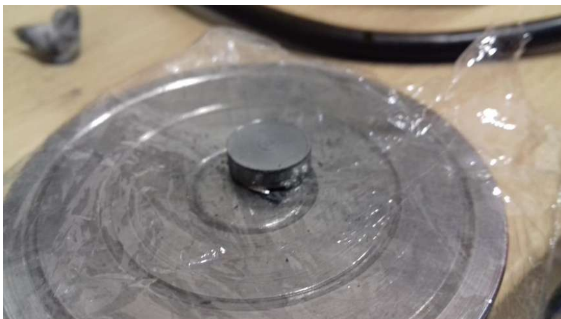
Figura 4.109. Imagen de las piezas en verde obtenidas por prensado uniaxial de los polvos de molienda Al-Mg reforzados con NTC.
