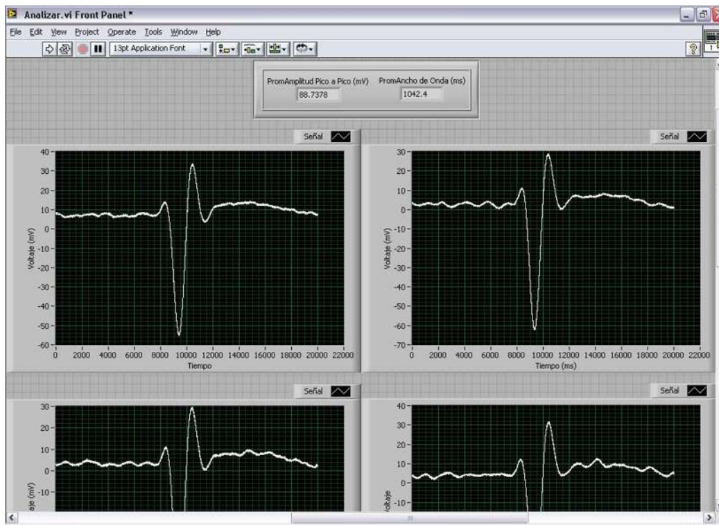
Figura 2.17 Panel frontal del programa elaborado en LabVIEW.
