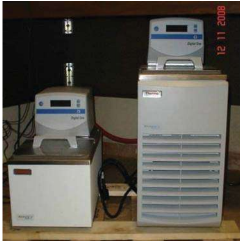
Figura 2.9 Unidades generadoras del flujo de calor
