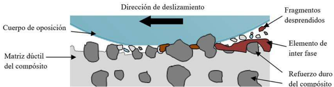
Figura 2.11 Ilustración esquemática de la fase de partículas duras que protegen a la matriz dúctil de la abrasión.
