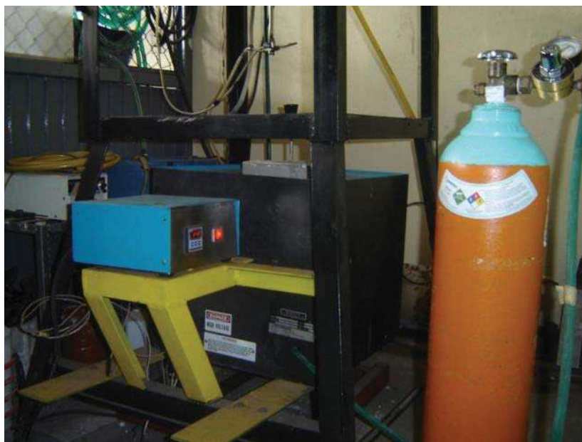
Figura 4.9 Horno eléctrico, el cual utiliza argón como atmósfera protectora.
