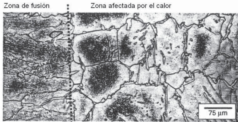
Figura 2.18 Microestructura de la ZAT en un acero inoxidable tipo 430. Se observa la presencia de martensita en los límites de grano y la gran precipitación intragranular.
