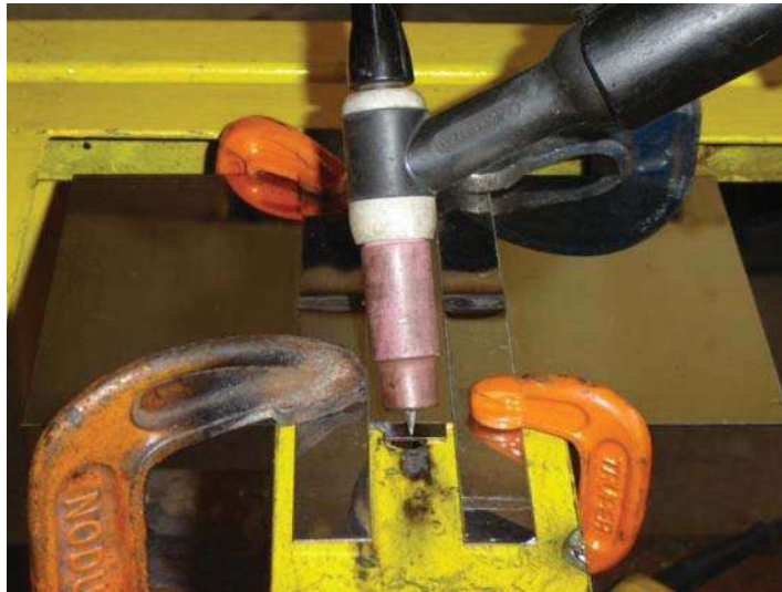
Figura 3.1 Fotografía de las láminas a ser soldadas, fijadas con prensas.
