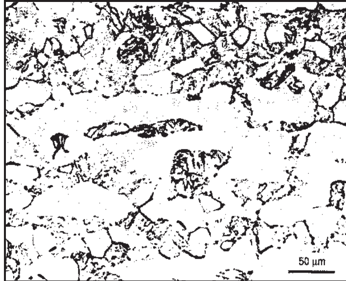
Figura 2.10 Microestructura del acero 430 recocido a 1100 °C y enfriado hasta temperatura ambiente
