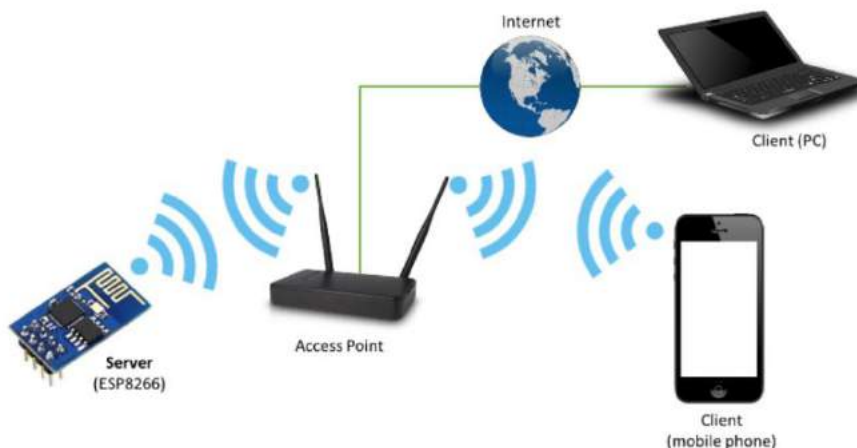
Figura 2.11: Esquema de funcionamiento como servidor [75].
