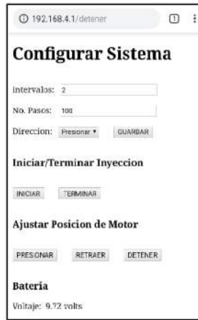
Figura 4.21: Interfaz fácil de usar basada en Android para controlar el microinyector.
