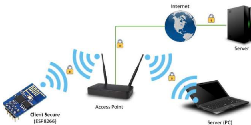
Figura 2.10: Esquema de funcionamiento como cliente seguro [75].
