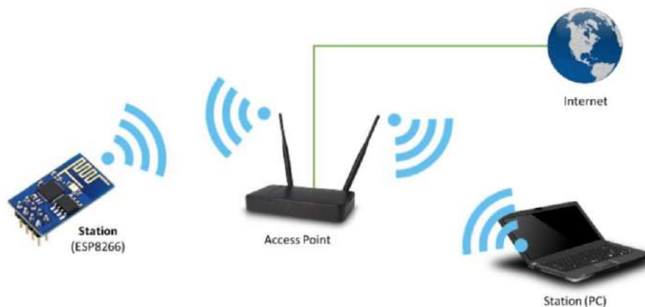
Figura 2.7: Esquema de funcionamiento como estación [75].
