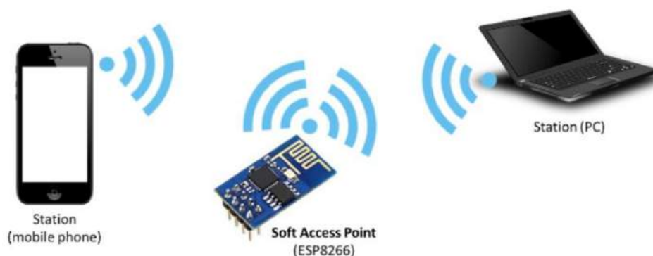
Figura 2.8: Esquema de funcionamiento como punto de acceso SoftAp [75].
