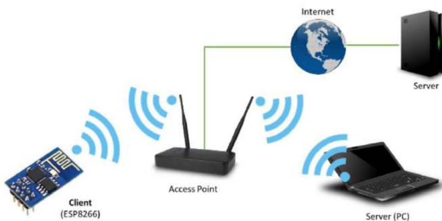
Figura 2.9: Esquema de funcionamiento operando como cliente [75].
