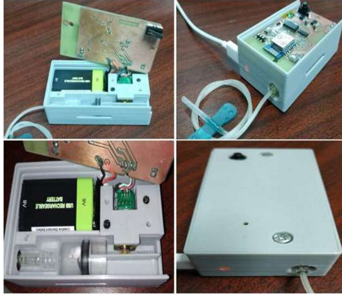
Figura 4.19: Microinyector con sus componentes colocados en sus respectivos compartimentos.
