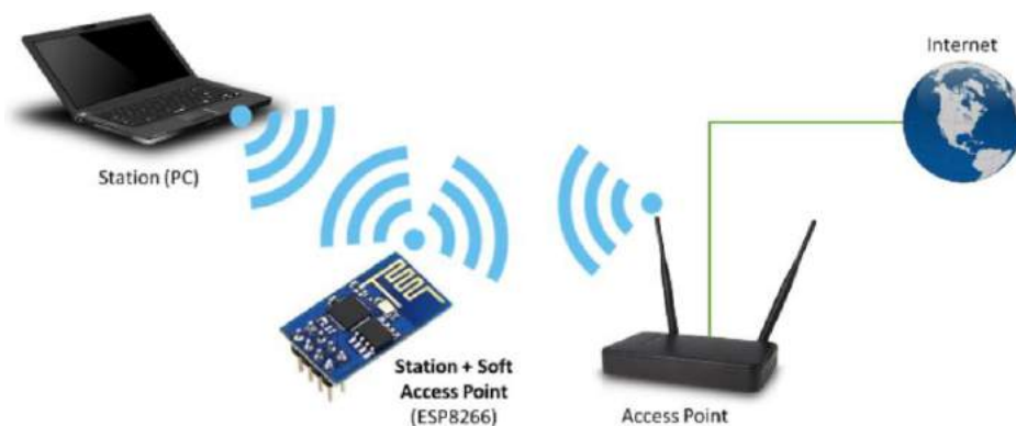
Figura 2.6: Esquema de funcionamiento como estación y punto de acceso [75].
