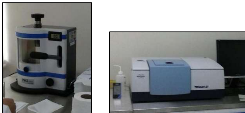
Figura 10. Equipo utilizado en la medición en la espectroscopía a) Presurización de las muestras con bromuro de potasio. b) espectrofotómetro FTIR marca Bruker® Modelo Tensor 27.
