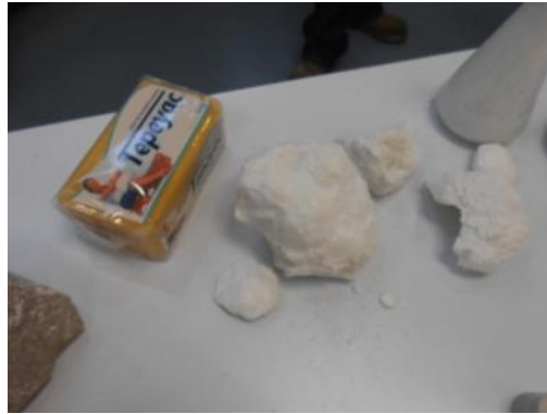
Figura 41. Jabón utilizado para impermeabilizaciones. Foto. MGDC.
