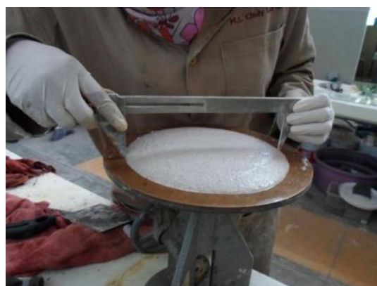
Figura 21. Medición en el diámetro del mortero extendido una vez que se sacudida la mesa. Foto: JAVP
