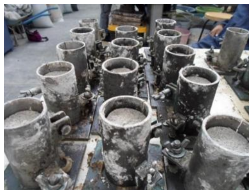
Figura 19. Cilindros (nótese la contracción de la mezcla en aproximadamente un 10% de la longitud)
