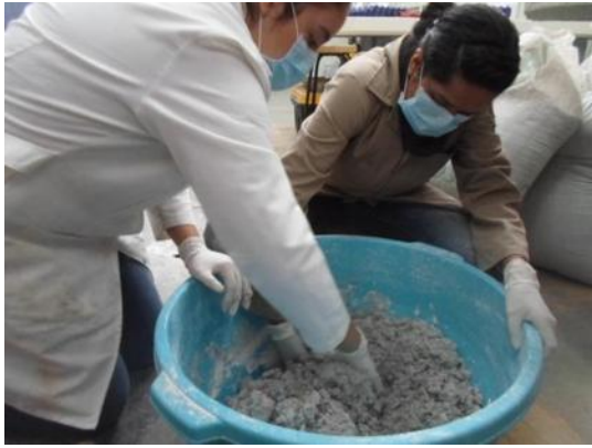
Figura 11. Amasado manual de la mezcla. Foto: AJVP
