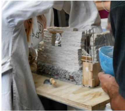
Figura 1. Trabajos de los alumnos de la ENCRyM, donde utilizan el nopal como aditivo en mortero de cal. (Foto: MGDC, 2014)
