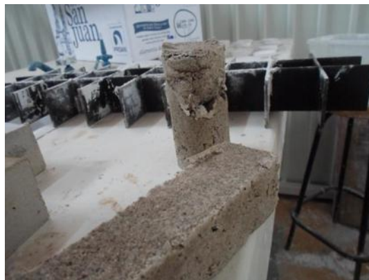
Figura 25. Desmoronamiento de mezcla con yema de huevo.
