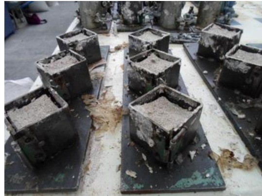
Figura 27. Retracción en muestras de mortero con clara de huevo.
