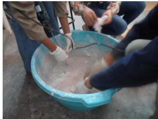
Figura 14. Adición de algodón al mortero al 3%
