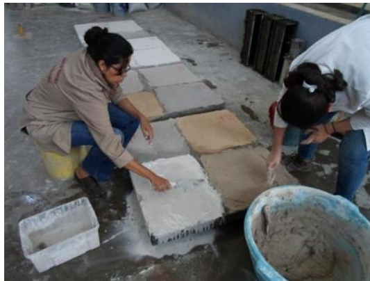
Figura 28. Sangrado en losa en la aplicación de mortero con leche como aditivo.
