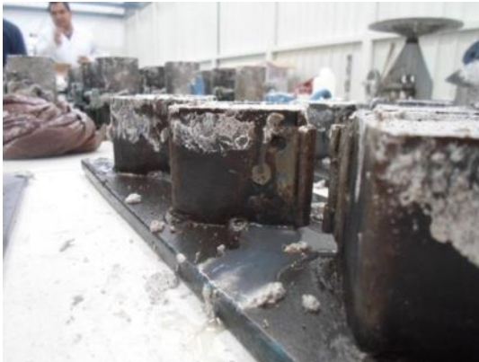
Figura 26. Sangrado durante el proceso de fraguado con aditivo de clara de huevo
