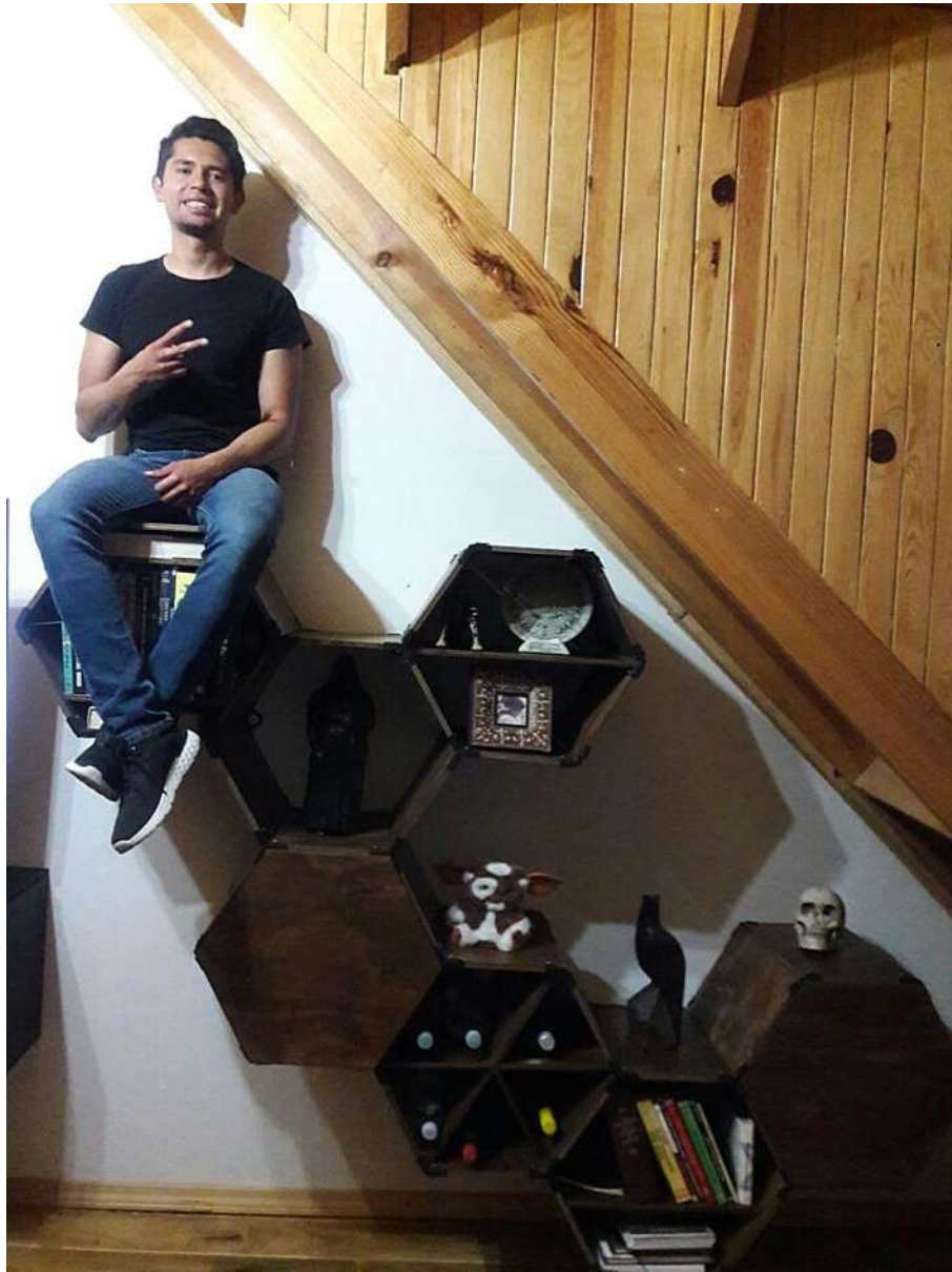
Figura 8.1 Prueba de resistencia del prototipo de mueble con retícula modular
