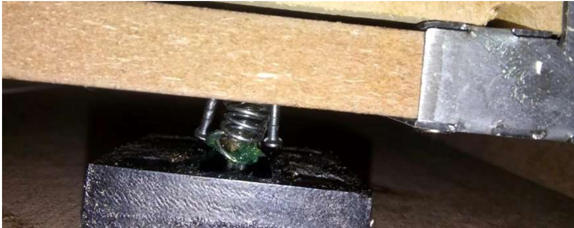
Figura 6.31 Imagen de la prueba de funcionamiento cuando el pistón se encuentra atrancado en el nivel 3.
