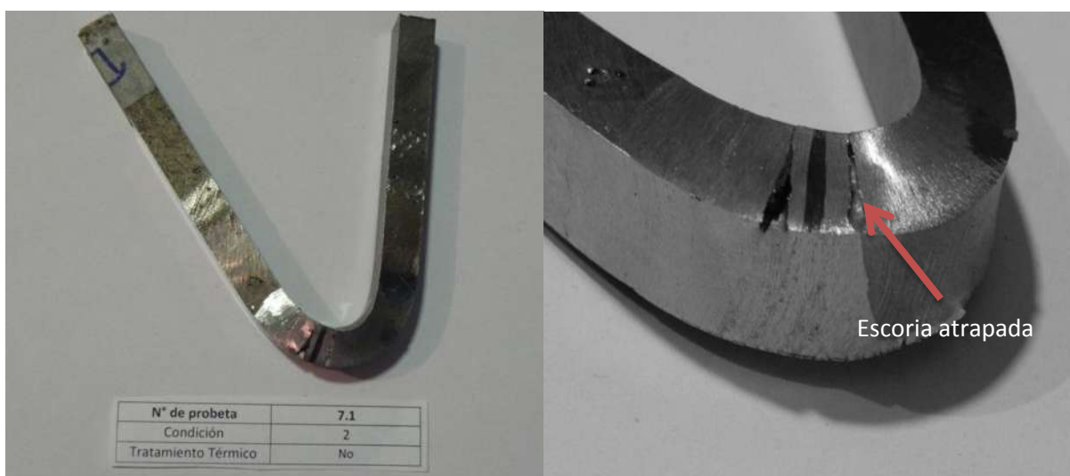
Figura 3. 31.- Probeta de doblez en donde se muestra atrapamiento de escoria.
