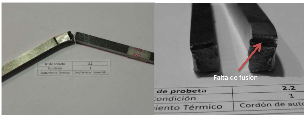
Figura 3. 32.- Probeta de la placa 2 la cual falla a causa de falta de fusión.
