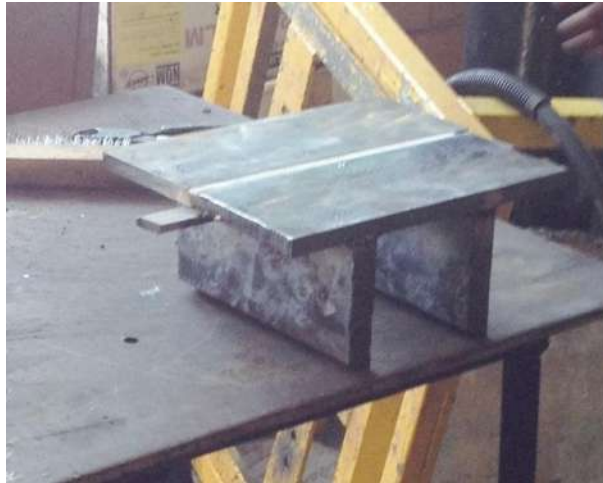
Figura 2. 3.- Arreglo de las placas punteadas, con biselado en “V” con 1/4 separación, respaldo y los puentes en la parte inferior.
