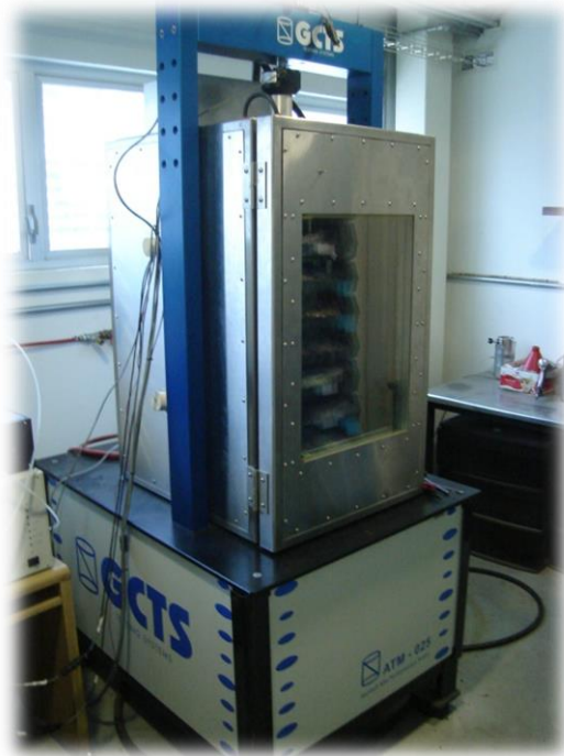
Figura 3.8. Prensa universal GCTS capaz de realizar módulo resiliente, dinámico, leyes de fatiga para carpetas asfálticas y pruebas triaxiales para capas granulares
